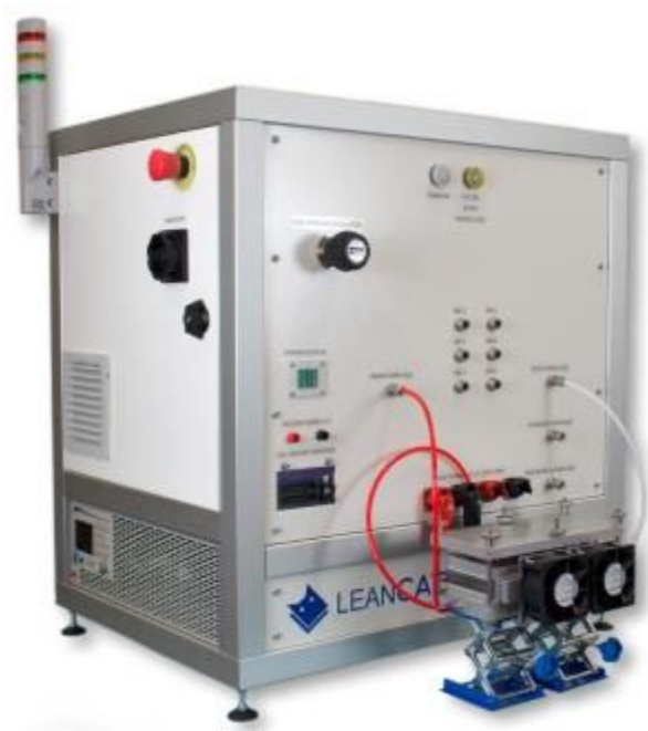
Σχήμα 5.3 : LeanCat OBT - Διάταξη Ελέγχου συστοιχίας ανοιχτής καθόδου
