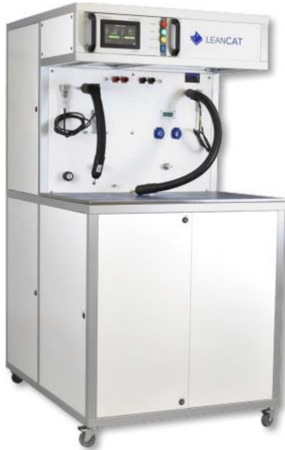
Σχήμα 5.6 : LeanCat PTS – 100 – Διάταξη Ελέγχου συστοιχιών
