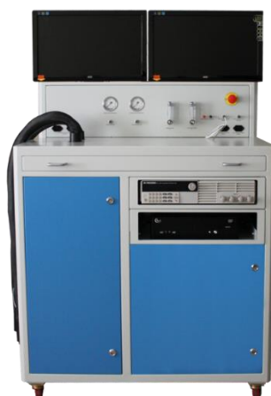
Σχήμα 5.2 : Διάταξη ελέγχου κυψελών καυσίμου TSFC PRO-601
