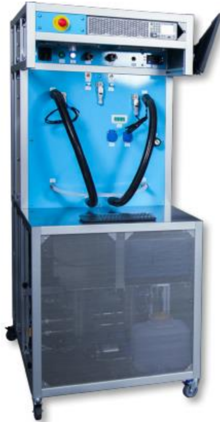
Σχήμα 5.5 : LeanCat PTS-10 - Διάταξη ελέγχου για μοναδιαία κυψέλη και μικρές συστοιχίες
