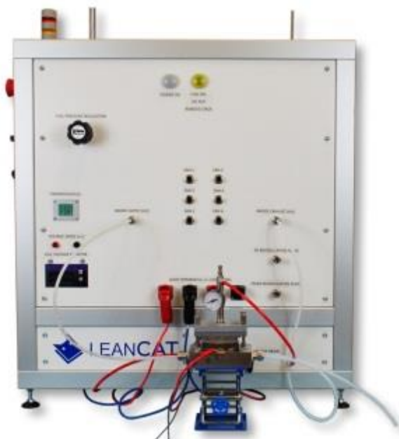
Σχήμα 5.4 : LeanCat PBT - Διάταξη ελέγχου μοναδιαίας κυψέλης
