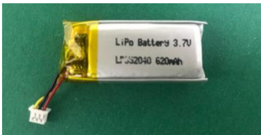
Εικόνα 21 Hot Lithium Polymer Battery 620mAh
