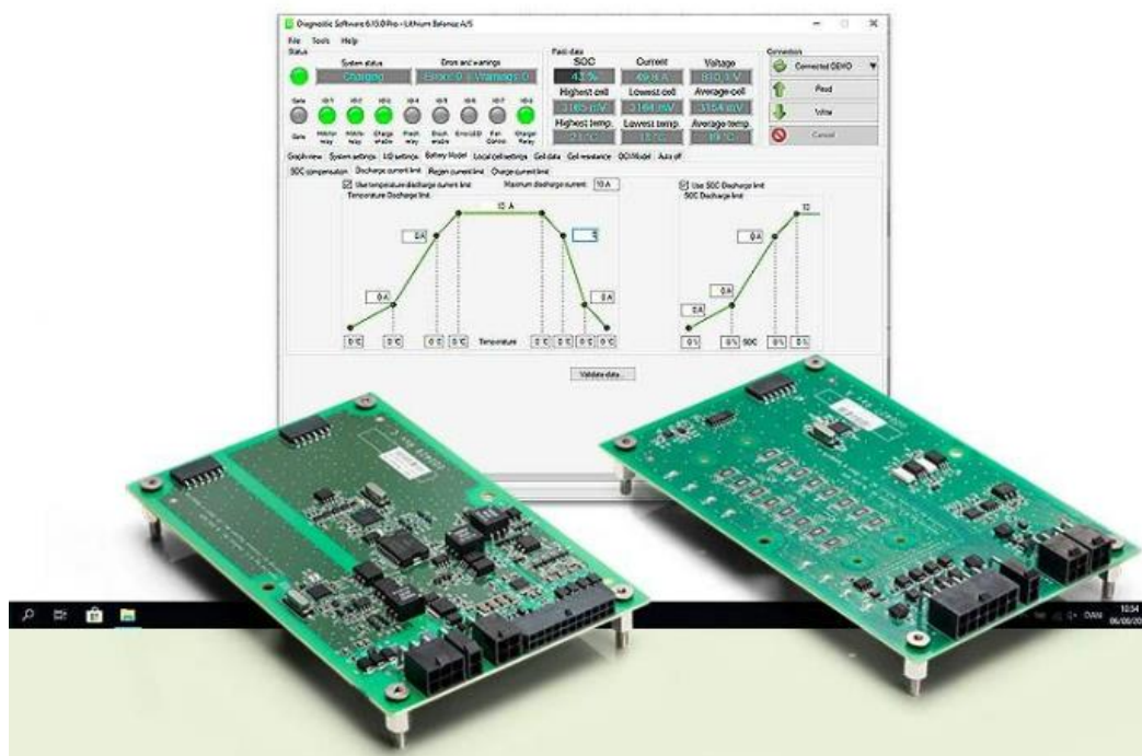
Εικόνα 28 s-BMU με λογισμικό
