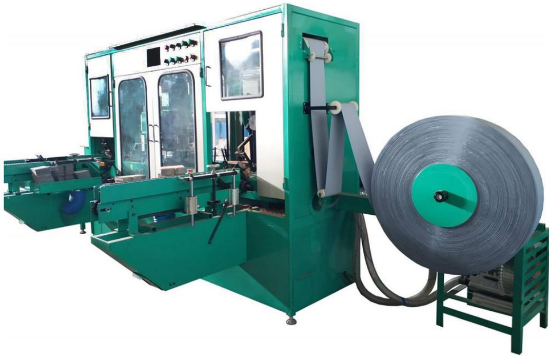
Εικόνα 7: Μηχάνημα αυτόματης στοίβαξης και με πλάκα -διαχωριστικό
