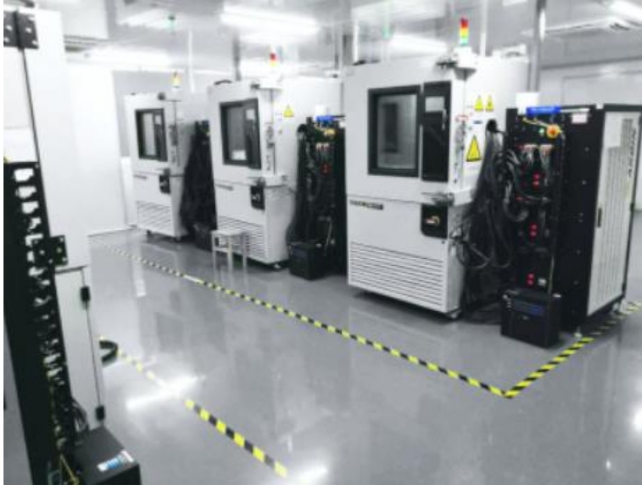
Εικόνα 24 Καμπίνες διάγνωσης μπαταριών Arbin
