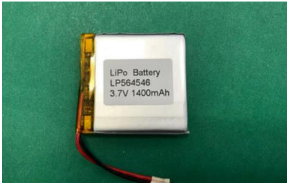
Εικόνα 16 Μπαταρία πολυμερής λιθίου 3.7V 1400 mAh
