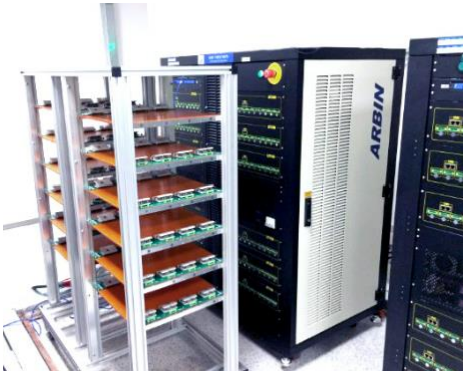
Εικόνα 25 Μπαταρίες άνω των 10V σε καμπίνες για διάγνωση της εταιρείας Arbin
