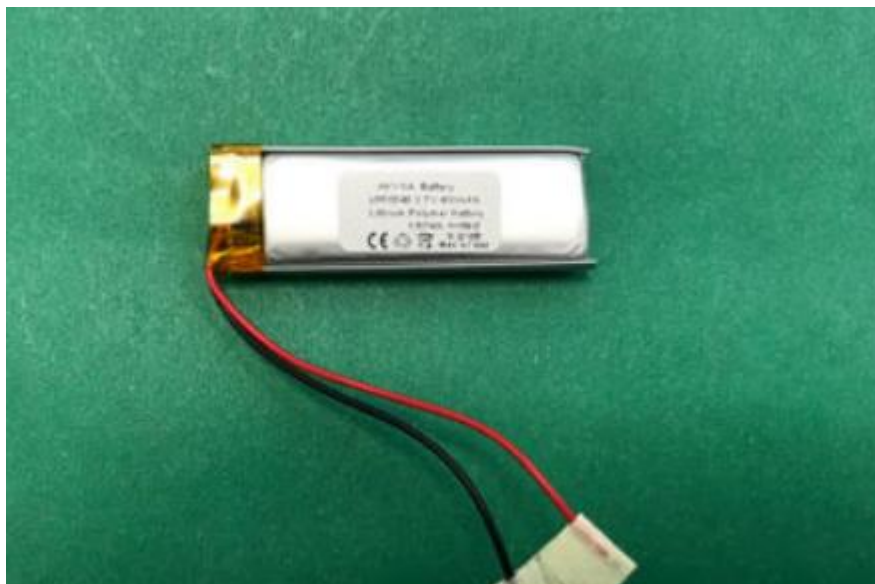
Εικόνα 20 Μπαταρία Λιθίου τόξου 450 mAh
