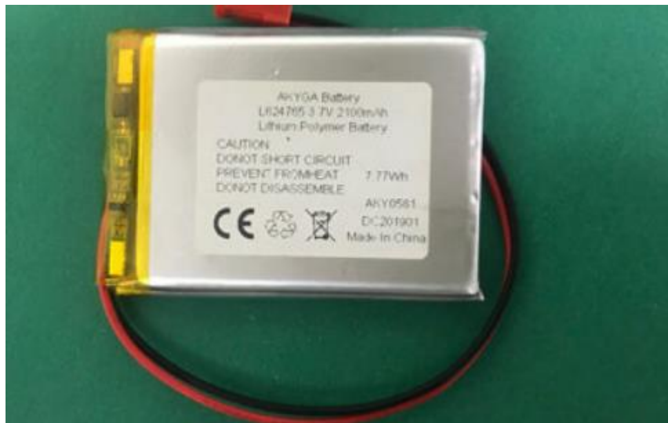
Εικόνα 18 Επαναφορτιζόμενη μπαταρία λιθίου πολυμερής 3.7V
