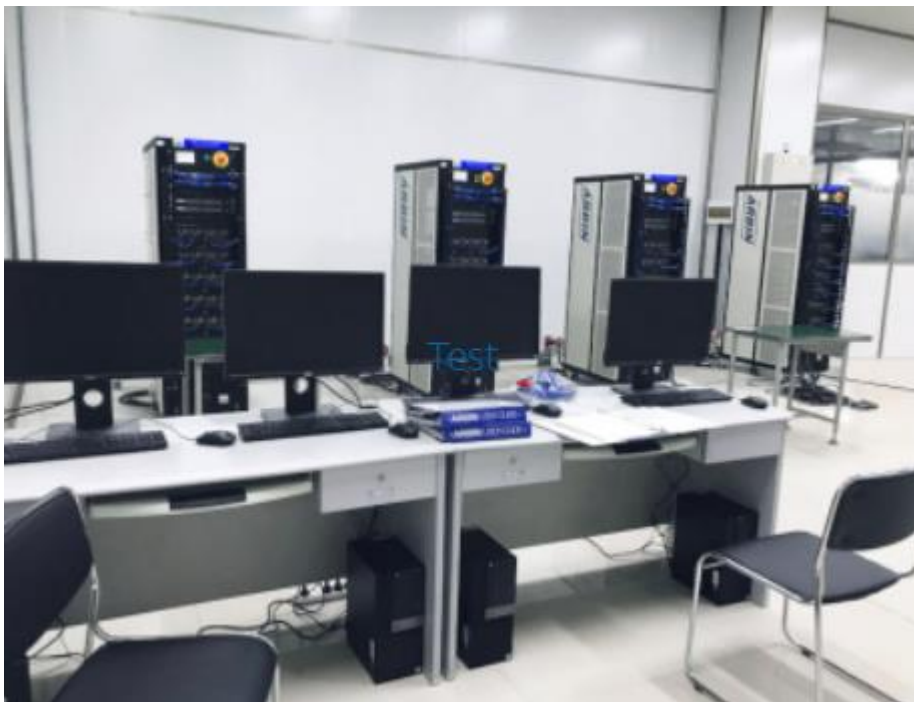
Εικόνα 23 Μηχανήματα Arbin για τεστάρισμα μπαταριών
