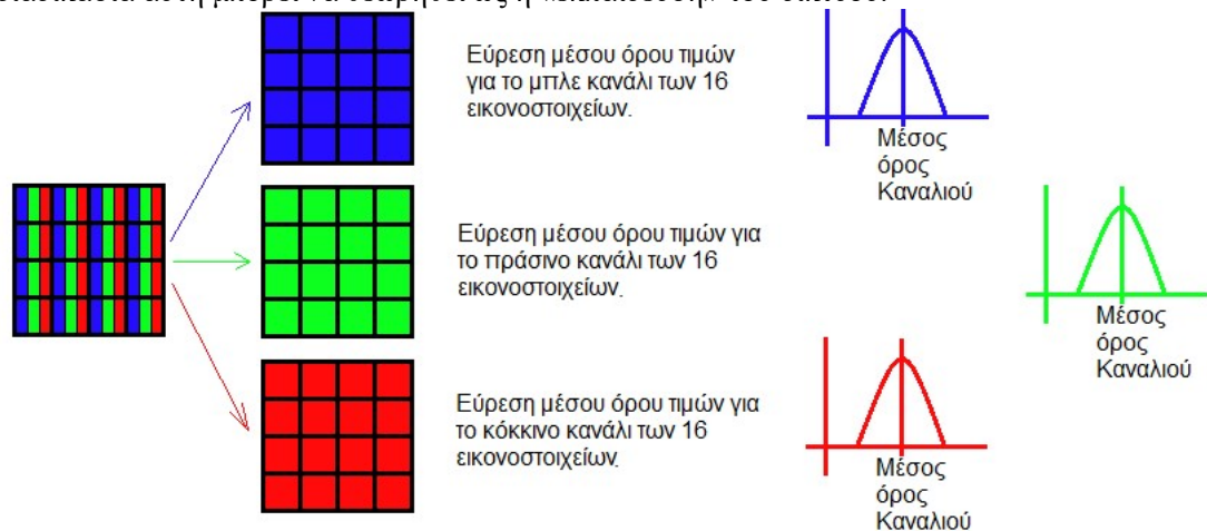
Γράφημα 1: Απεικόνιση της μεθόδου, βάση της οποίας χρησιμοποιούνται τα δεδομένα των δειγμάτων προτύπων για την εκπαίδευση των νευρώνων του δικτύου
