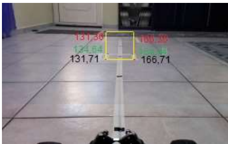
Εικόνα 3: Ληφθέν στιγμιότυπο, χρησιμοποιούμενο για τη βαθμονόμηση της αλλαγής προοπτικής
