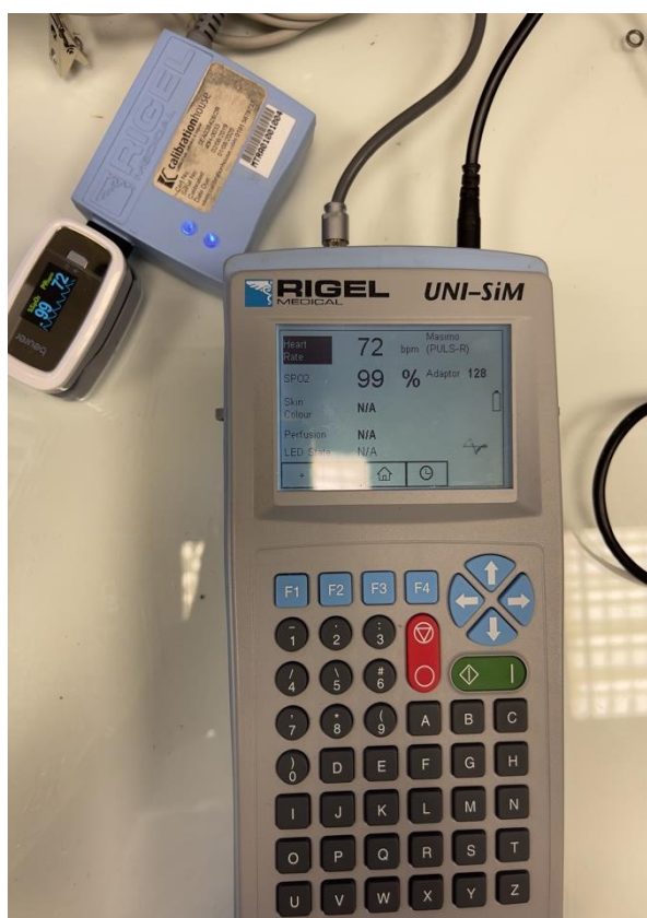
Εικόνα 122. Έλεγχος κοινού Οξυμέτρου με το Rigel Uni-SiM
