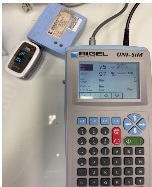
Εικόνα 123. Έλεγχος κοινού Οξύμέτρου με το Rigel Uni-SiM
