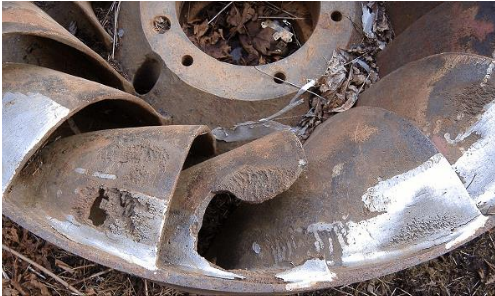
Εικόνα 3.2: Συνέπειες της σπηλαίωσης σε στροφείο (πηγή: διαδίκτυο)
