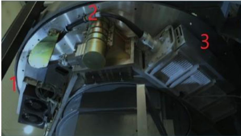
Εικόνα 11: Σε αυτή την εικόνα από το gantry του XT2100HS διακρίνονται το Σύστημα Ψύξης (1), ο Αγωγός ακτίνων X (2) και η Γεννήτρια υψηλής τάσης (3).
