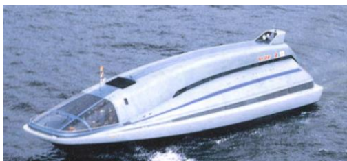
Σχ. 1.3.1 Πλοίο προωθούμενο μέσω ΜΗΔ διάταξης
