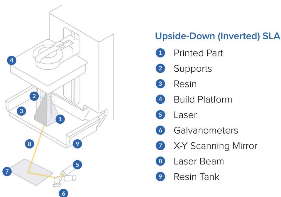
Εικόνα 6: Απεικόνιση τρισδιάστατης εκτύπωσης SLA (formlabs.com)
