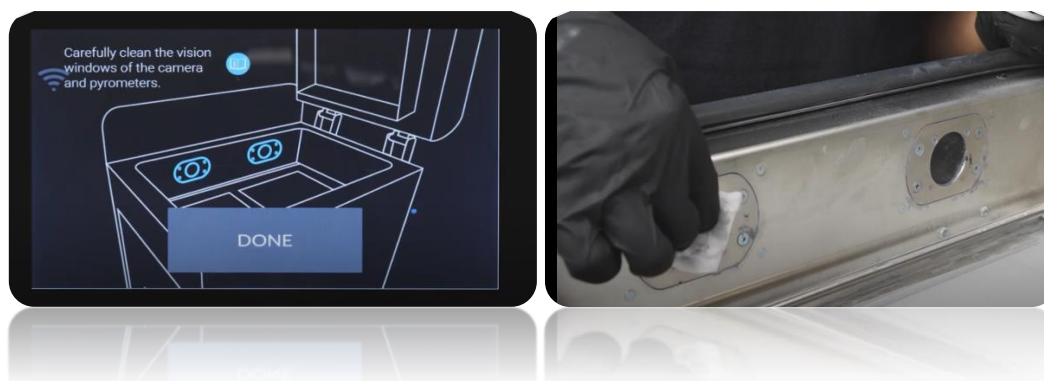
Εικόνα 37: Βήμα 6ο Καθαρισμός πυρομέτρων
