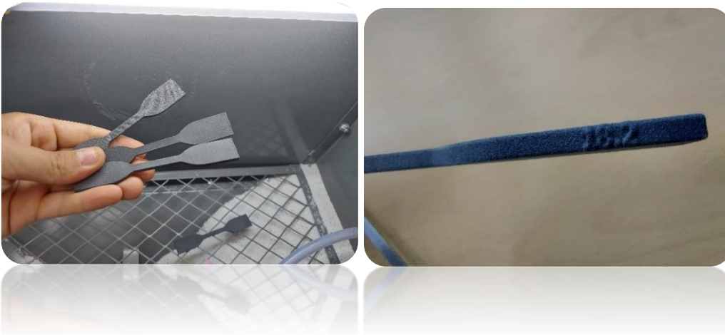
Εικόνα 44: Αποτέλεσμα μετά την διεργασία της αμμοβολής
