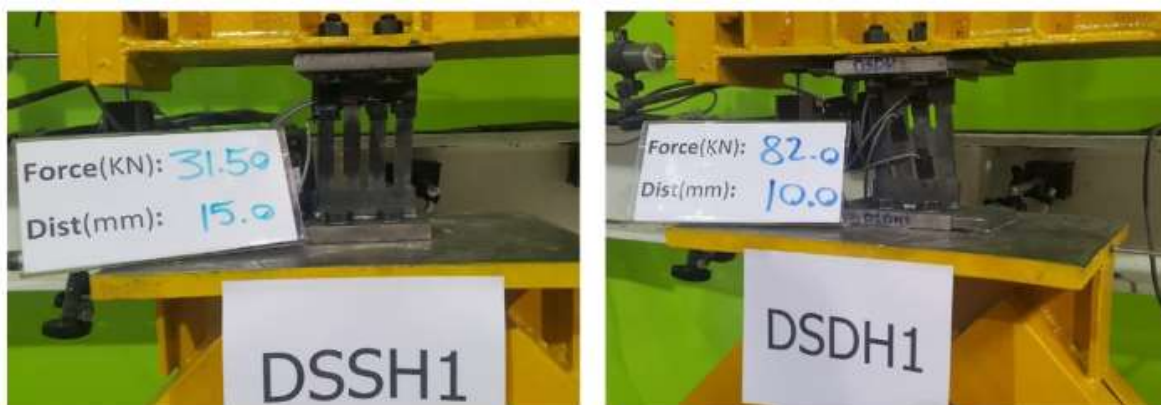
Εικόνα 5.30 Παραμορφώσεις έπειτα από πειραματικές δοκιμές σε αποσβεστήρες από χάλυβα με σχισμή εγκατεστημένο σε στήριγμα \Lambda (chevron)
