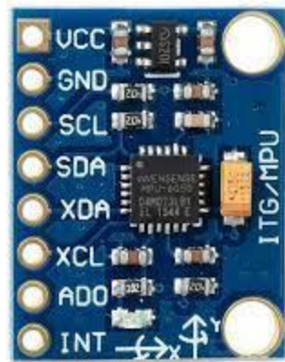
Εικόνα 5.2.5 Ηλεκτρονικό γυροσκόπιο MPU-6050[52]
