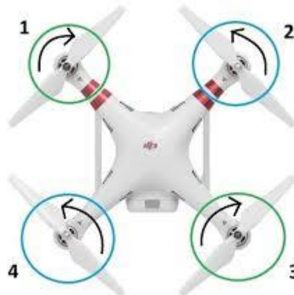
Εικόνα 3-2-1. Απεικόνιση τετρακόπτερου με αρίθμηση προπελών και την ανάλογη περιστροφή τους
