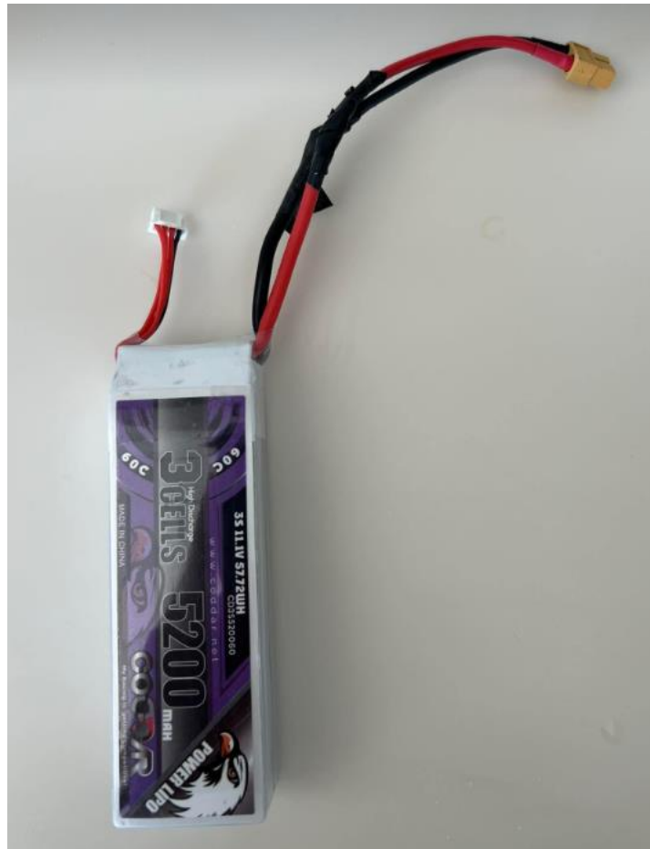
Εικόνα 5.2.7 Μπαταρία λιθίου του τετρακοπτέρου
