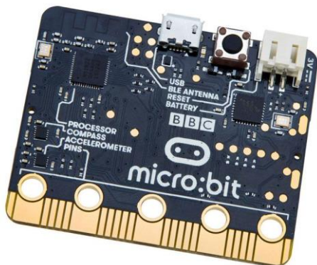
Εικόνα 8: Η πλακέτα BBC Micro:bit. Πηγή: http://www.dagurobot.com/micro-bit
