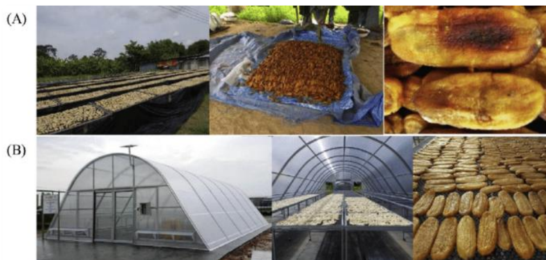
Εικόνα 23: (A) παραδοσιακή ξήρανση μπανάνας στον ήλιο, (B) ηλιακός ξηραντήρας παραβολικού σχήματος (researchgate.net).
