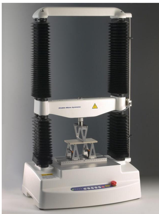
Εικόνα 29: Αναλυτής υφής TA.HD Plus texture analyzer (Stable Micro Systems Ltd., UK) (scancotec.com).
