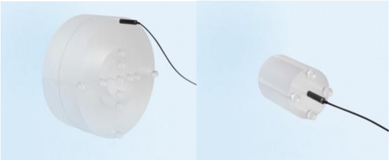
ΕΙΚΟΝΕΣ 15, 16 : Το ομοίωμα ελέγχου δείκτη δόσης της QUART [ 9 ]
