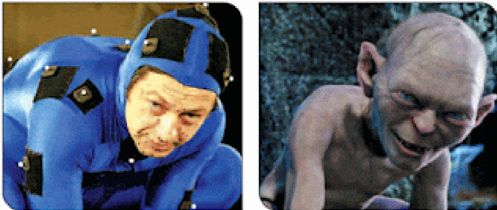
Εικ.3.18 Ο Andy Serkis (αριστερά) φοράει μια στολή με σημάδια (markers). Κάμερες και υπολογιστής συλλέγουν τις πληροφορίες από τα σημάδια της στολής που χρησιμοποιούνται για να κουνήσουν τον ψηφιακό χαρακτήρα του Gollum.
