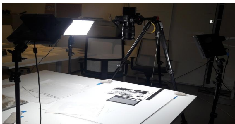
Εικ.38: Η διάταξη της κάμερας και των φωτιστικών πηγών για τη λήψη φωτογραφιών στην ορατή περιοχή, με προσπίπτοντα φωτισμό.
