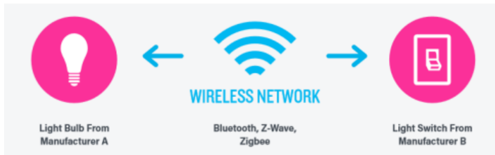
Εικόνα 3 Μοντέλο επικοινωνίας Device to Device [12]
