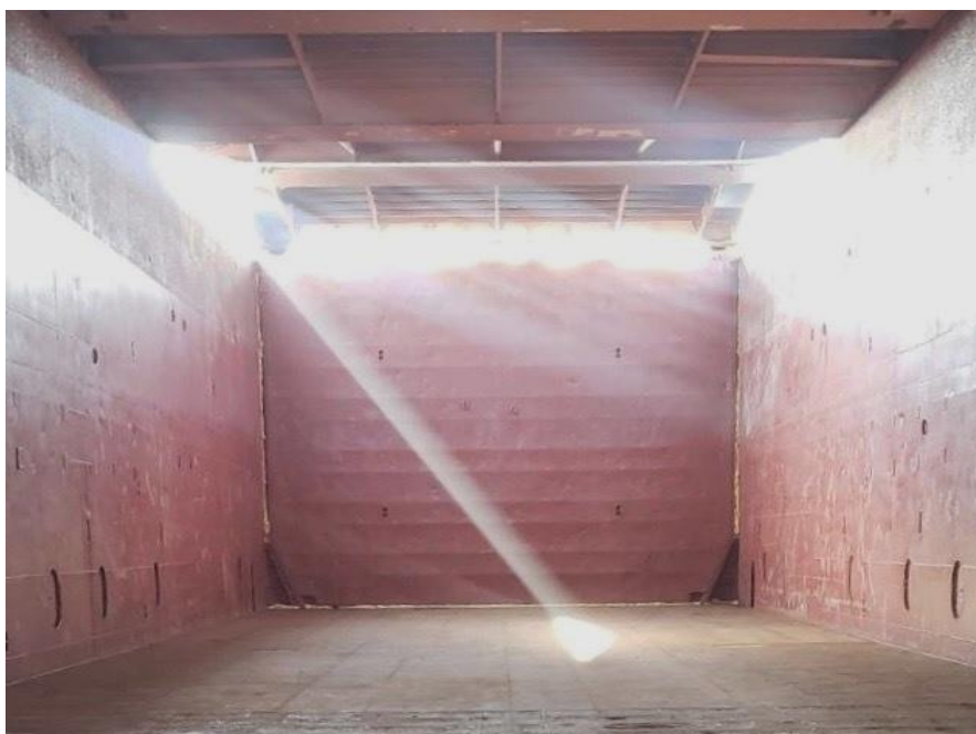
Εικόνα 8-1: Τοποθετημένη αποσπώμενη φρακτή.
