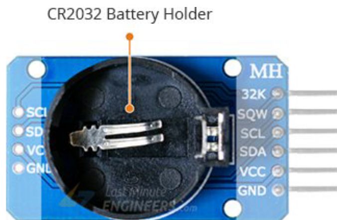
Εικόνα 2.22: Θέση μπαταρίας στο module ( https://lastminuteengineers.com/ds3231-rtc-arduino-tutorial/ )
