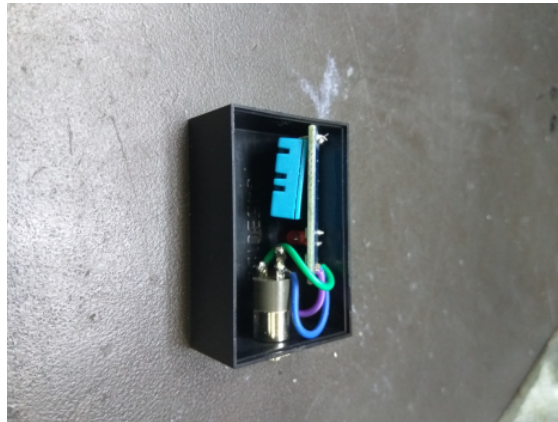
Εικόνα 3.7: Αισθητήρας DHT11 σε ξεχωριστό αποσπώμενο κουτί
