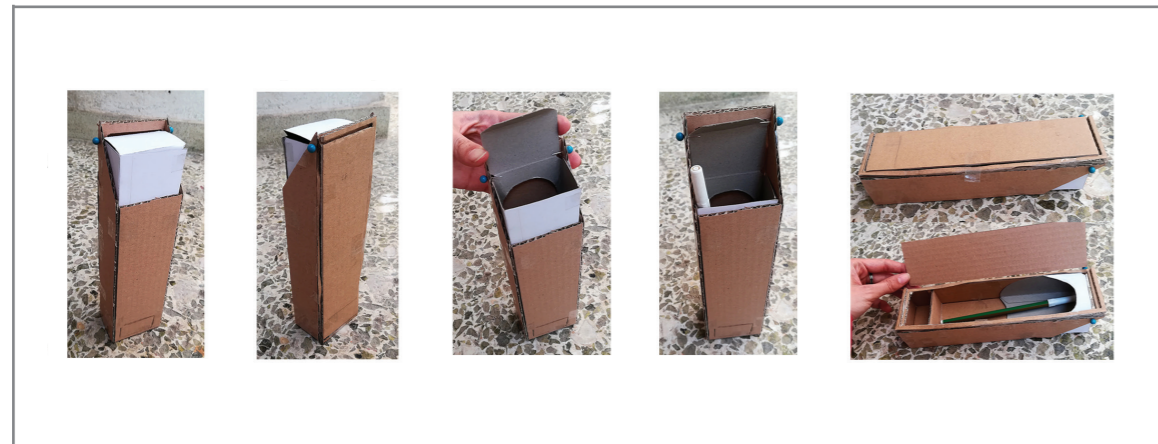
Εικόνα 18 Μακέτα: Κατασκευή δύο τμημάτων. Μια μπάρα συγκρατεί το εσωτερικό τμήμα όταν είναι κλειστό. Όταν ανοίγει, η ίδια μπάρα το οδηγεί καθώς γλιστρά προς τα κάτω για να αποκαλύψει το εσωτερικό της κασετίνας. Αυτό το σχέδιο ήταν πλήρως λειτουργικό από την πρώτη κι όλας κατασκευή.
