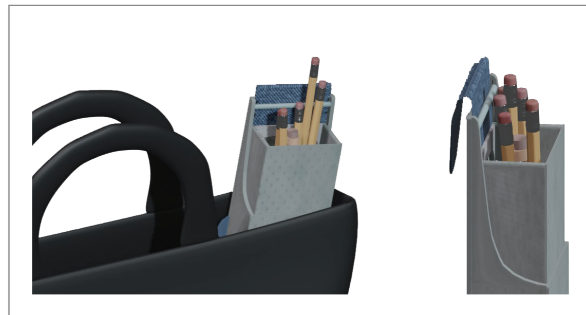
Εικόνα 116 Στην ART, ανεπαίσθητες σχεδιαστικές αλλαγές ώστε να ανοίγει το καπάκι μέσα στην τσάντα.
