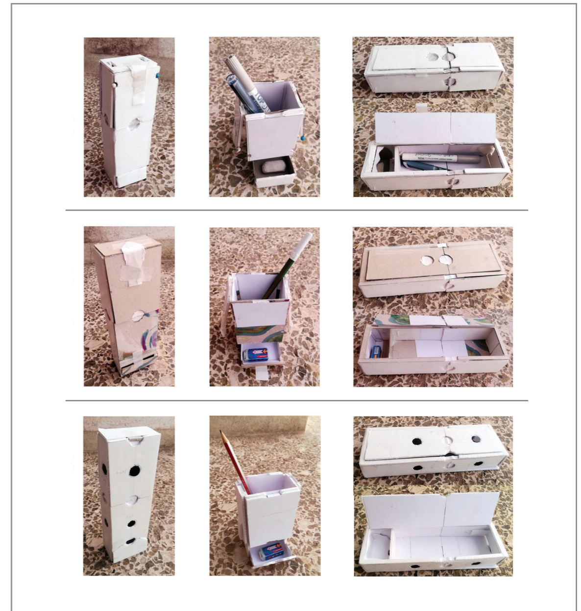
Εικόνα 40 Μακέτες: Το κλείσιμο στο πάνω μέρος λειτουργεί καλά. Στις μακέτες δοκιμάστηκαν επίσης οι λύσεις για τα "αυτιά" που πετάνε (βλ. επόμενη σελίδα). Τέλος, δοκιμάστηκαν και διάφορες διαστάσεις.
