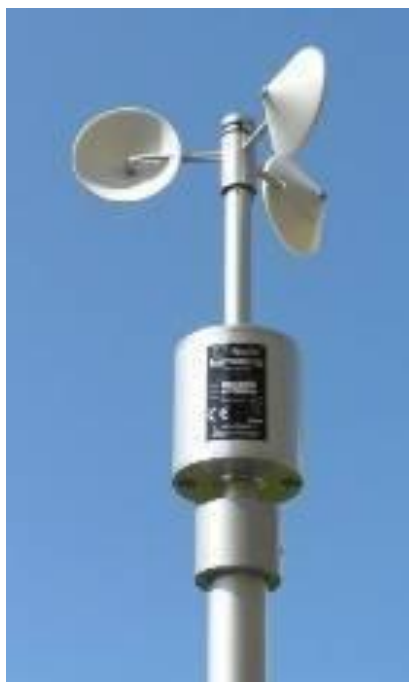
Εικόνα 10: Απεικόνιση ανεμόμετρου (Στεργιόπουλος, 2021).
