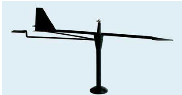
Εικόνα 11: Ανεμοδείκτης (Πηγή: Οικονομοτεχνική μελέτη αιολικού πάρκου, Μπαρπαρήγου Μυρτώ 2011).
