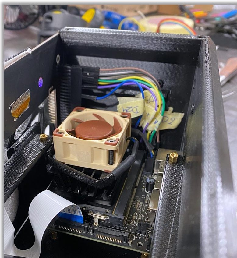
Εικόνα 56 Εγκατάσταση του αναπτυξιακού Jetson
