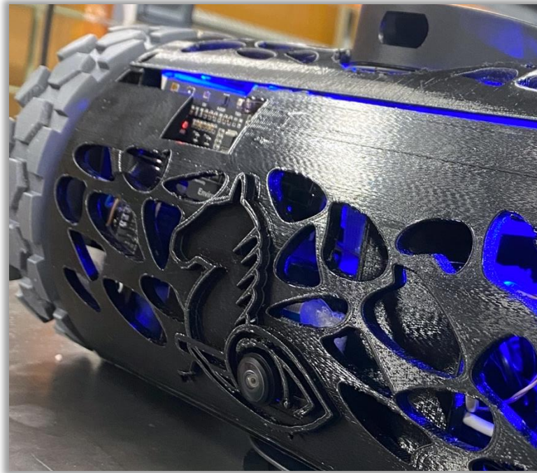
Εικόνα 57 Τοποθέτηση κάμερας στην μπροστινή όψη του Scopus
