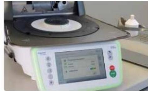
(Εικ.84) Το σύστημα τοποθετείται στο θερμικό κέντρο του φούρνου όπτησης και ξεκινά το πρόγραμμα. (67)
