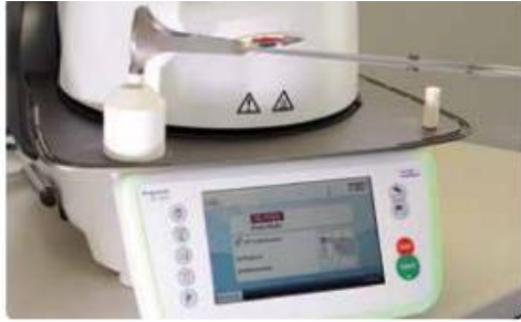
(Εικ.82) Στην συνέχεια, τοποθετείται το έμβολο IPS Multi One-Way Plunger (67)
