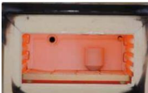
(Εικ.79) Ο κύλινδρος τοποθετείται στον φούρνο με την οπή προς τα κάτω (67)
