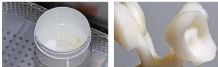
(Εικ.37), (Εικ.38) Αφαιρείται το επιφανειακό στρώμα με IPS e.max Press Invex Liquid σε συσκευή υπερήχων (67)
