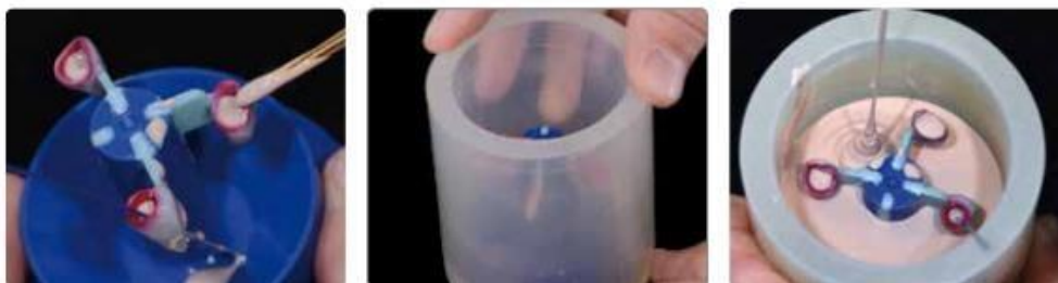
(Εικ.70) Προσεκτική τοποθέτηση μικρής ποσότητας πυροχώματος στις εσωτερικές επιφάνειες των ομοιωμάτων (67)
