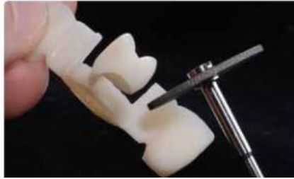
(Εικ.41) Διαχωρισμός των IPS e.max Press Multi με δίσκο διαχωρισμού (67)
