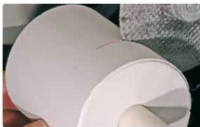
(Εικ.30), (Εικ.31) Με ένα δίσκο διαχωρίζεται το σημείο το οποίο είναι η ένωση του εμβόλου με το πλίνθωμα (67)
