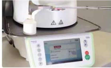
(Εικ.82) Στην συνέχεια, τοποθετείται το έμβολο IPS Multi One-Way Plunger (67)
