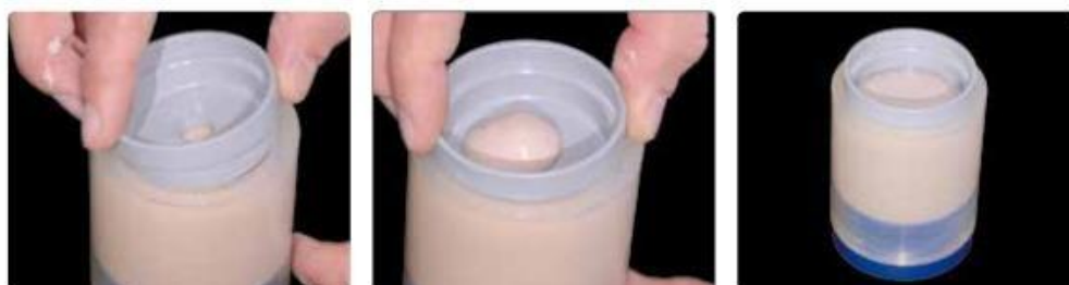
(Εικ.73),(Εικ.74),(Εικ.75) Έγχυση του υλικού μέχρι την ειδική σήμανση του δακτυλίου, τοποθέτηση του IPS Ring Gauge και απομάκρυνση της περίσσειας του πυροχώματος (67)
