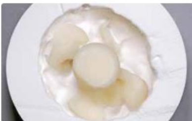
(Εικ.32), (Εικ.33) Αμμοβολή αντικειμένου με πίεση 4 bar (67)
