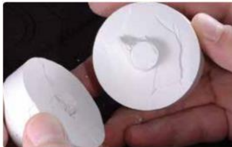
(Εικ.86) Ο δακτύλιος σημειώνεται 30 mm από την βάση του και κόβεται με δίσκο. (67)
