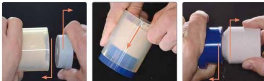
(Εικ.76) Ο μετρητής αποσπάται με περιστροφική κίνηση (67)
