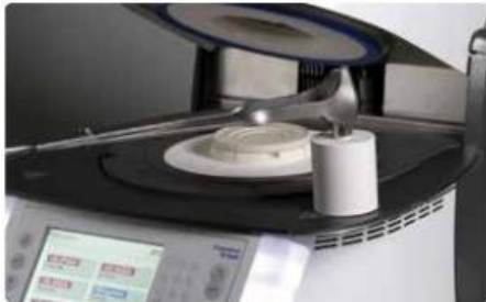
(Εικ.25) Το έμβολο τοποθετείται από την πλευρά η οποία έχει επικαλυφθεί με την σκόνη (67)
