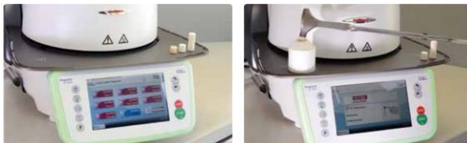
(Εικ.80) Επιλέγεται το επιθυμητό πρόγραμμα ενώ παρέχεται IPS Multi One-Way Plunger, IPS Alox Plunger και IPS e.max Press Multi σε θερμοκρασία δωματίου. (67)
