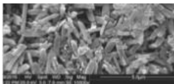
(Εικ.3)SEM εικόνα, μικροδομή υλικού CELTRA PRESS (37)
