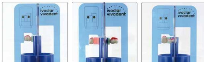
(Εικ.63) Με την βοήθεια του οδηγού (IPS Multi Sprue Guide) υπολογίζεται η θέση της αποκατάστασης (67)
