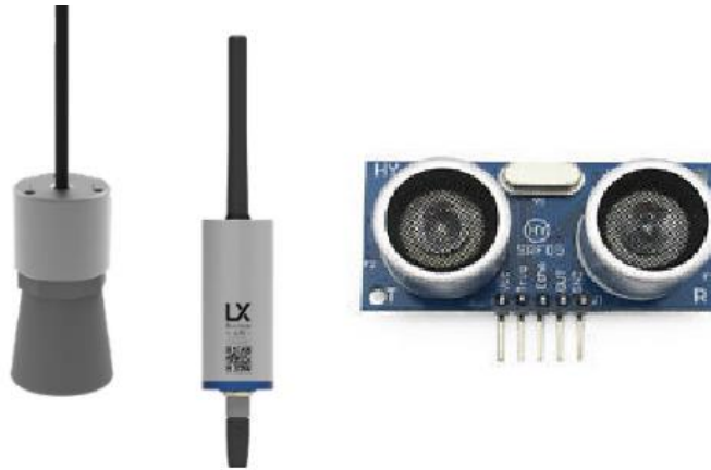
Εικόνα 7 Αισθητήρες υπερήχων. Αριστερά επαγγελματικός αισθητήρας, Δεξιά πειραματικός αισθητήρας, μικρής απόστασης
