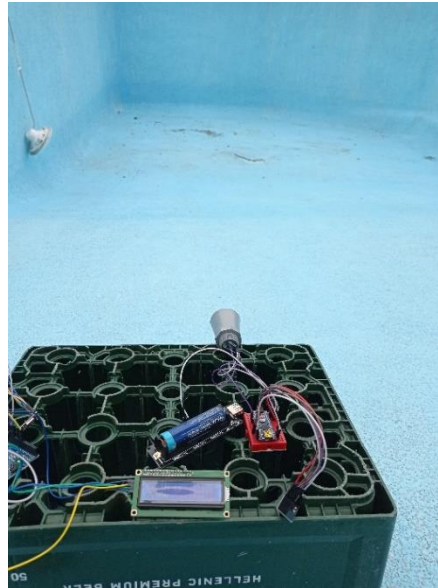
Εικόνα 13 Μέτρηση απόστασης αισθητήρα μέχρι την στέρη επιφάνεια
