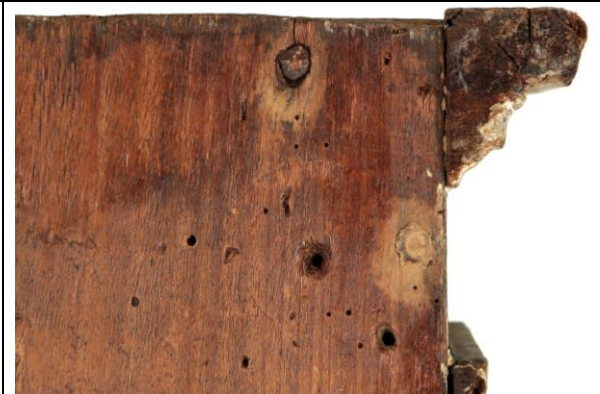
Εικόνα 3. 41: Κατασκευαστική λεπτομέρεια της κορνίζας από το πίσω μέρος και οπές από ξυλοφάγα έντομα.
