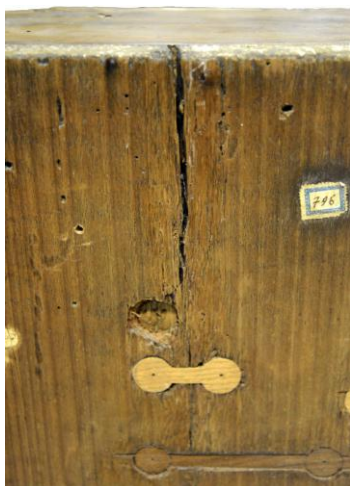
Εικόνα 2. 8: Σχισμή του ξύλου στο πίσω μέρος του έργου, ξύλινοι σύνδεσμοι και οπές από ξυλοφάγα έντομα. Πηγή: Προσωπικό αρχείο
