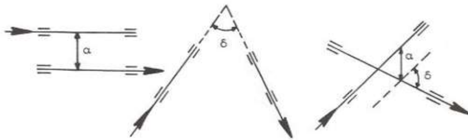
Σχήμα 1.2: Σχετική θέση αξόνων συνεργαζόμενων τροχών [1]
