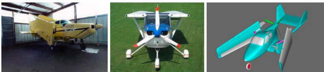
Εικόνα 1.4 Ιδέες στοιβαγμένης διαμόρφωσης για την αποθήκευση ή τη ρυμούλκηση προσωπικού αεροσκάφους: παραδείγματα περιλαμβάνουν το Stits Playmate, το διθέσιο EuroFox και το υδραυλικό φτερό αεροσκάφους SYNERGY για οδήγηση (Bovais, "Flight testing the Flying Radar Target (FLYRT)," AIAA-1994-2144, AIAA Biennial Flight, 1994).
