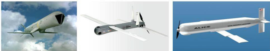
Εικόνα 1.1 Έννοιες άκαμπτων φτερών που περιλαμβάνουν SLAM-ER (πτύχωση με ψαλίδι), Coyote (δίπλωμα ψαλιδιού σε σειρά) και Alice (φτερό ταλάντευσης με εξωλέμβιο μεντεσέ) (Bovais, 1994).
