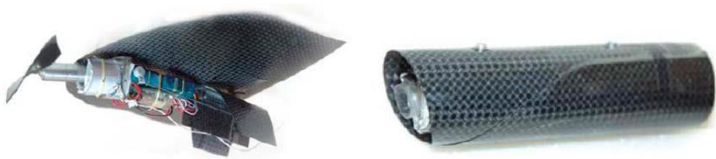
Εικόνα 1.5 MAV αντοχής με εύκαμπτο φτερό UF23 (Johnson, 2007).
