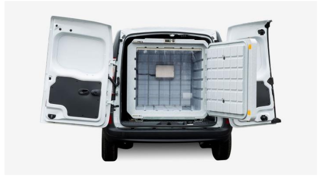
Εικόνα 18 φορτηγό ψυγείο τύπου μη αποσπώμενου θαλάμου
