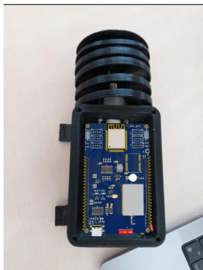
Εικόνα 66 Κουτί μαζί με την πλακέτα και τους αισθητήρες
