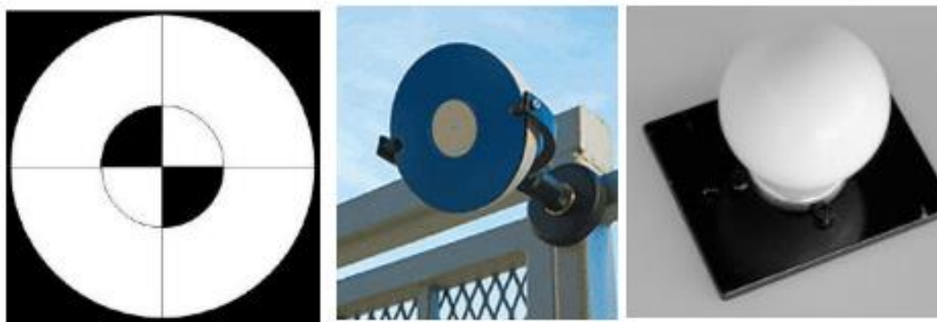
Εικόνα 11: Στόχοι για αποτυπώσεις με laser scanner [46]
