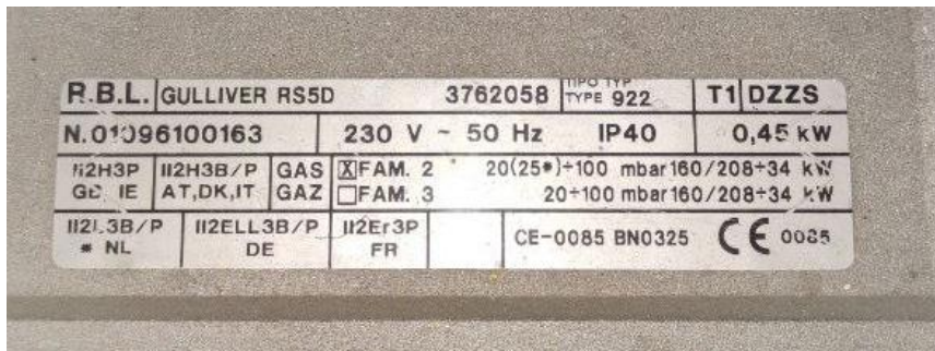
Εικόνα 31: Ετικέτα Καυστηρά Φυσικού Αερίου.
