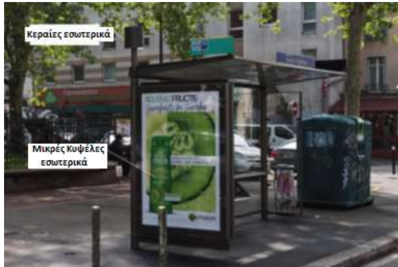
Εικόνα 44: Απεικόνιση Μικρών Κυψελών σε Διαφημιστικές Πινακίδες σε Στέγαστρο Στάσης Λεωφορείων.
