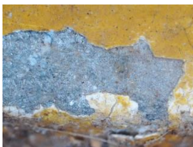
Εικόνα 42: Απώλεια χρωματικών στρωμάτων αφήνοντας εκτεθειμένο το μέταλλο (αλουμίνιο).
