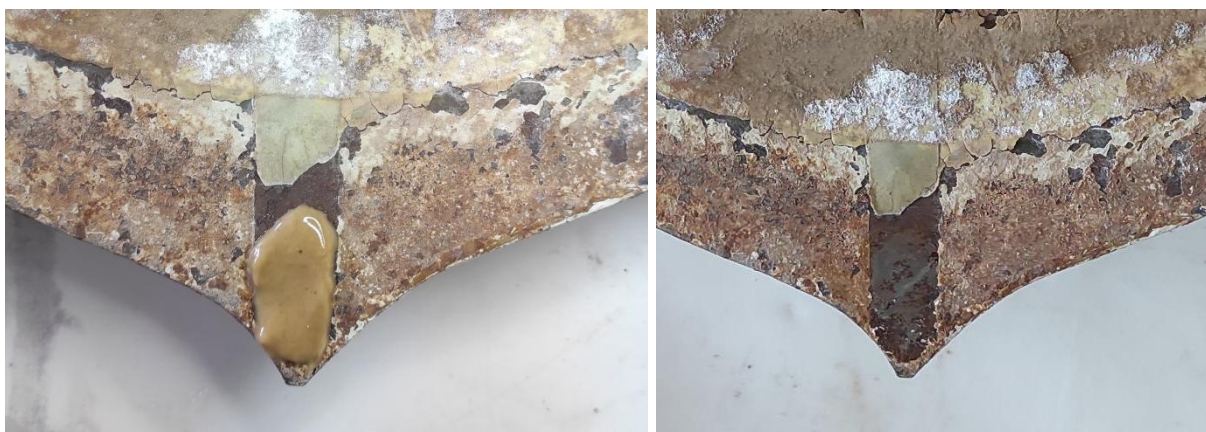
Εικόνα 85: Δοκιμή αφαίρεσης προϊόντων διάβρωσης από τον σίδηρο με κατιονική ρητίνη Ionex H.
