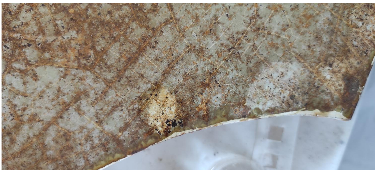
Εικόνα 87: Δοκιμή αφαίρεσης των προϊόντων οξείδωσης του σιδήρου από το γκρι χρωματικό στρώμα με: EDTA 5% w/v, NaOH 1 % w/v, κατιονική ρητίνη και ηλεκτροκίνητο τροχό.
