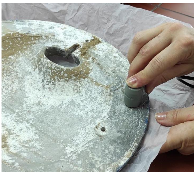
Εικόνα 56: Μέτρηση πάχους οξειδίου του αλουμινίου στην οπίσθια όψη της Βοιωτικής ασπίδας.
