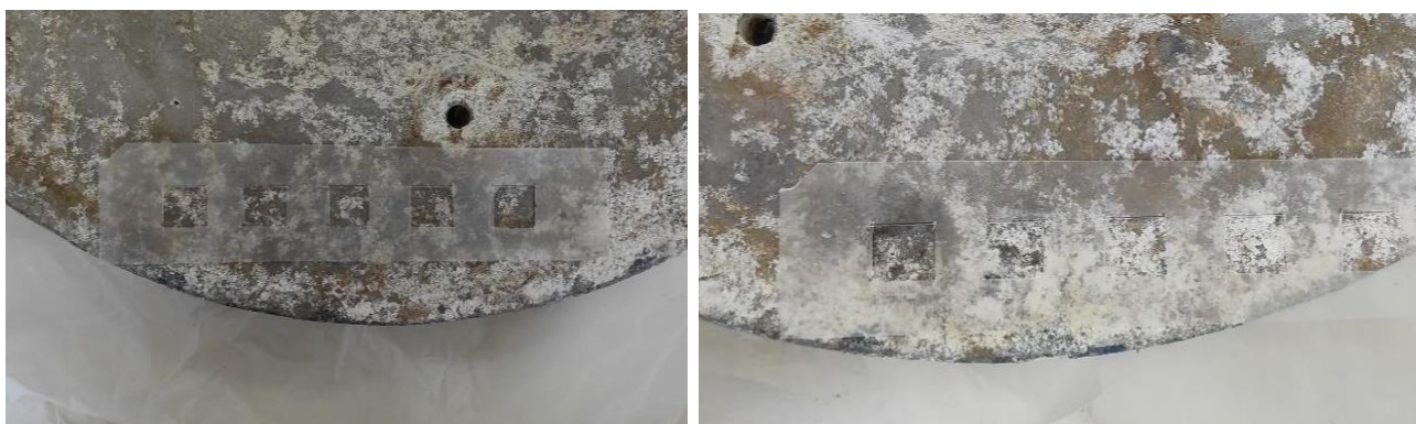
Εικόνα 92: 1 η περιοχή δοκιμών: 1) κιτρικό οξύ 2.5 % w/v, 2) κιτρικό τριαμμώνιο 5 % w/v, 3) φυτικό οξύ 5 % w/v, 4) μυρμηκικό οξύ 5 % w/v και 5) καυστικό νάτριο 5 % w/v.
