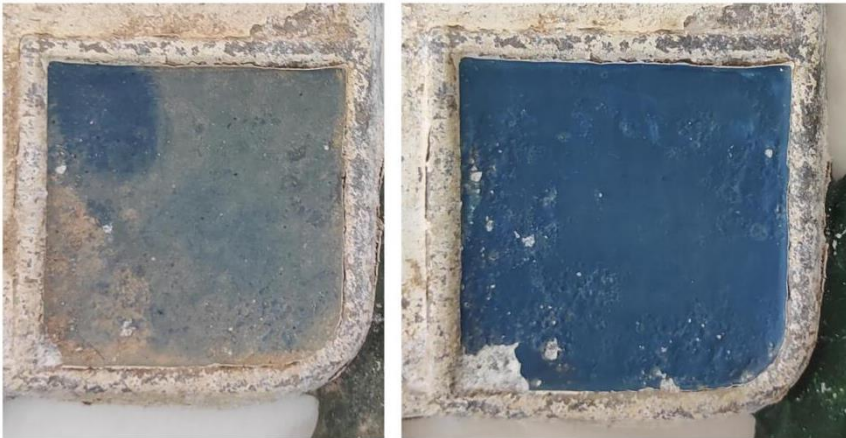
Εικόνα 80: Επιλεκτική αφαίρεση μπλε χρώματος μετά τη χρήση του Gel D.
