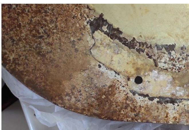
Εικόνα 88: Δοκιμή αφαίρεσης των προϊόντων οξείδωσης του σιδήρου από το λευκό χρωματικό στρώμα με: ηλεκτροκίνητο τροχό, κατιονική ρητίνη και EDTA 5 % w/v.
