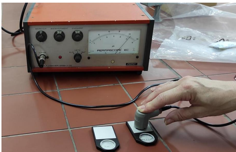
Εικόνα 54: Βαθμονόμηση οργάνου μέτρησης χρησιμοποιώντας δύο πρότυπα αλουμινίου (ανοδιωμένο και μη).
