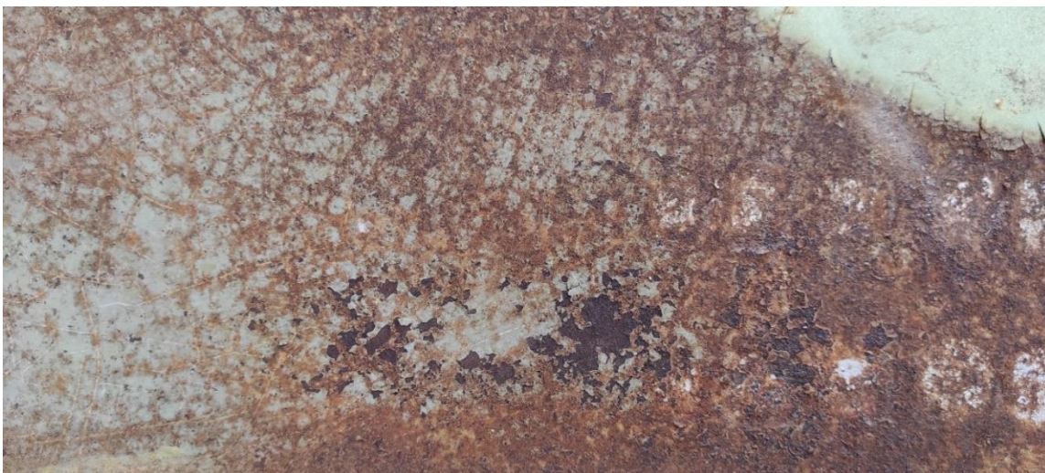
Εικόνα 27: Ανάπτυξη προϊόντων οξείδωσης πάνω από το στρώμα προετοιμασίας που χαρακτηρίζεται από εκτενές δίκτυο μικρο-ρηγματώσεων (κρακελάρισμα).
