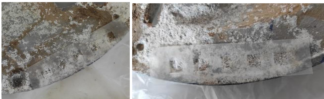
Εικόνα 94: 3 η περιοχή δοκιμών: 1) φυτικό οξύ 10 % w/v, 2) μυρμηκικό οξύ 5 % w/v και 3) EDTA 5 % w/v.
