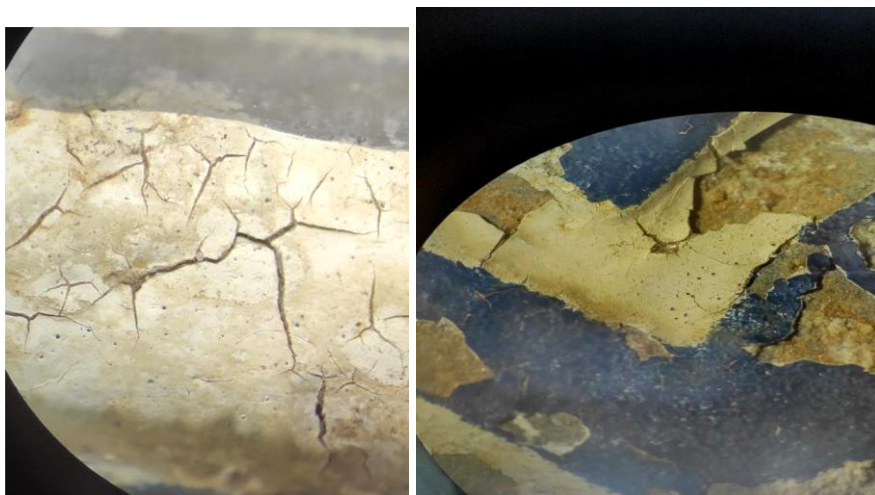
Εικόνα 72: Παρουσία υπολειμμάτων γέλης που έχει διεισδύσει μέσω τους δικτύου μικρο-ρωγμών των χρωματικών στρώματων.
