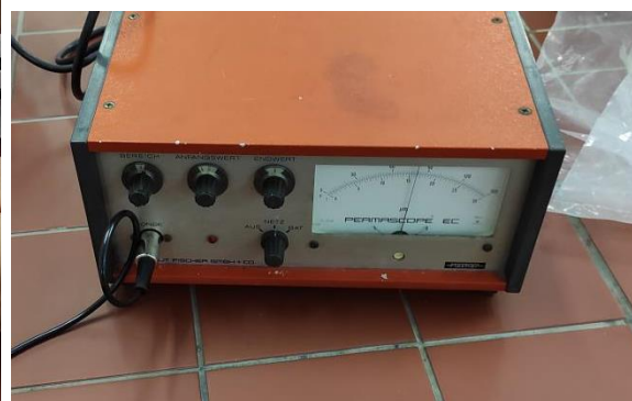
Εικόνα 56: Μέτρηση πάχους οξειδίου του αλουμινίου στην οπίσθια όψη της Βοιωτικής ασπίδας.
