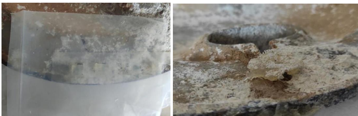
Εικόνα 96: Δοκιμές καθαρισμού με άκαμπτο άγαρ-άγαρ 3 % w/v - κιτρικό τριαμμώνιο και 5 % w/v και μυρμηκικό οξύ 5 % w/v.
