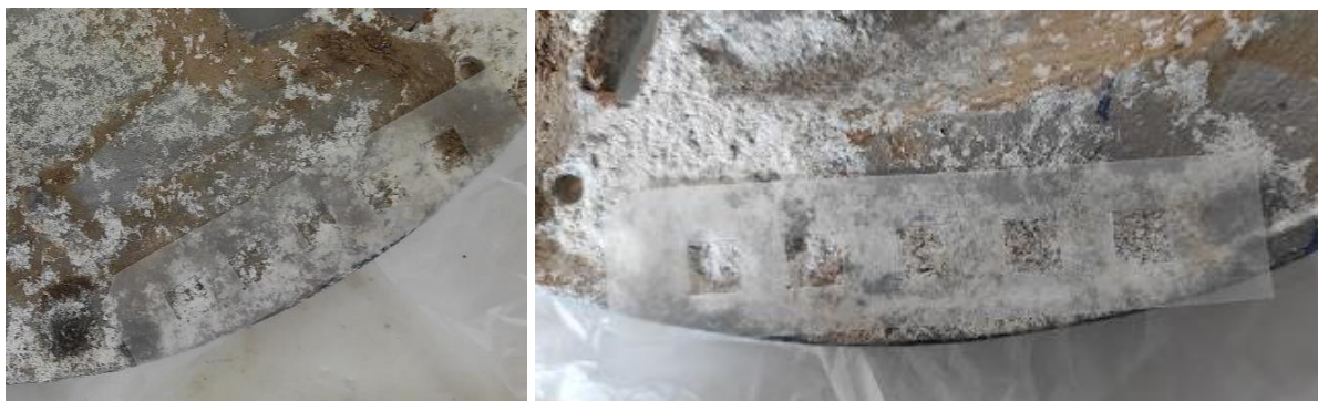
Εικόνα 90: 3 η περιοχή δοκιμών: 1) φυτικό οξύ 10 % w/v, 2) μυρμηκικό οξύ 5 % w/v και 3) EDTA 5 % w/v.
