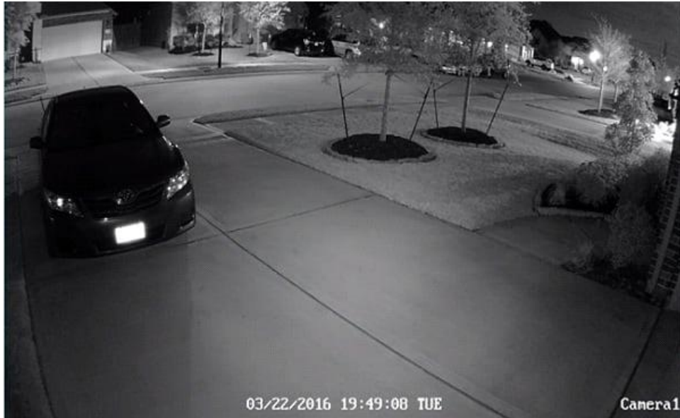
Εικόνα 19 Στιγμιότυπο από κάμερα παρακολούθησης με επιπρόσθετο φωτισμό υπέρυθρων
