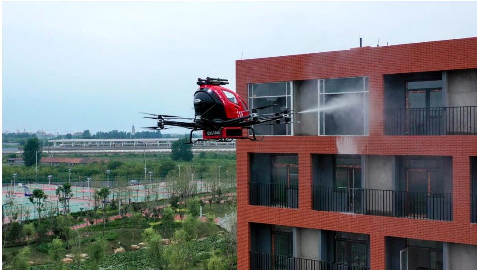
Εικόνα 52 Πυροσβεστικό Drone στην Κίνα που κάνει ρίψη πυροσβεστικού αφρού σε φλεγόμενο κτήριο
