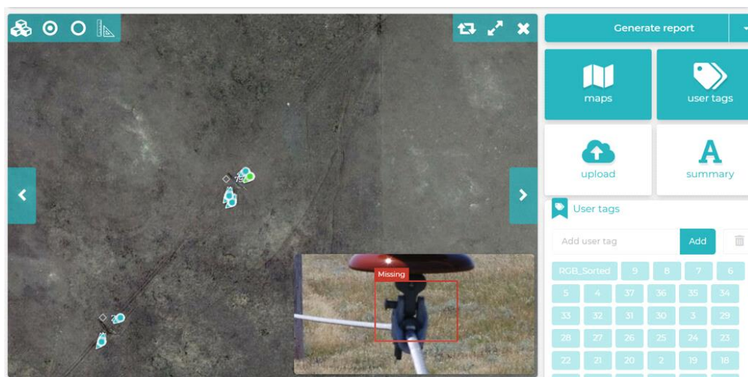
Εικόνα 55 Έλεγχος σε γραμμή διανομής ρεύματος με χρήση drone και λογισμικό της εταιρίας "measure an ageagle company"
