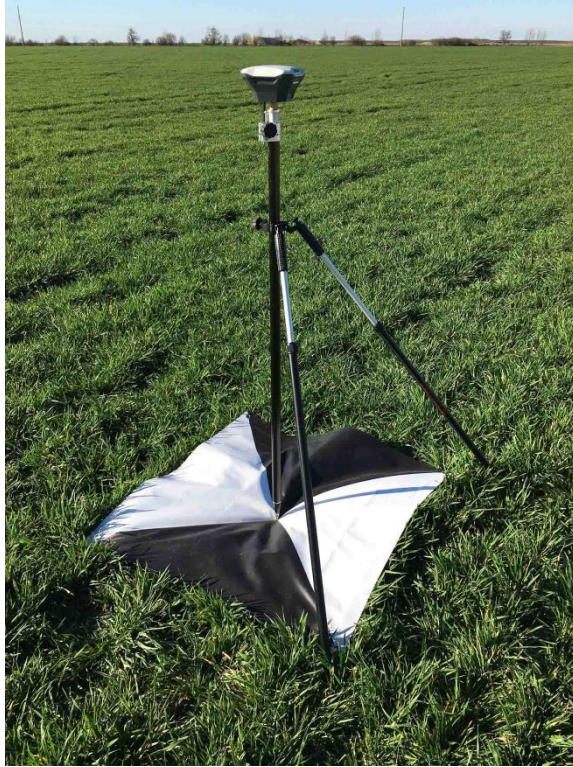
Εικόνα 41 Χρήση επίγειου δέκτη GNSS για την τοποθέτηση Σημείου Ελέγχου Εδάφους και Σήμανση του
