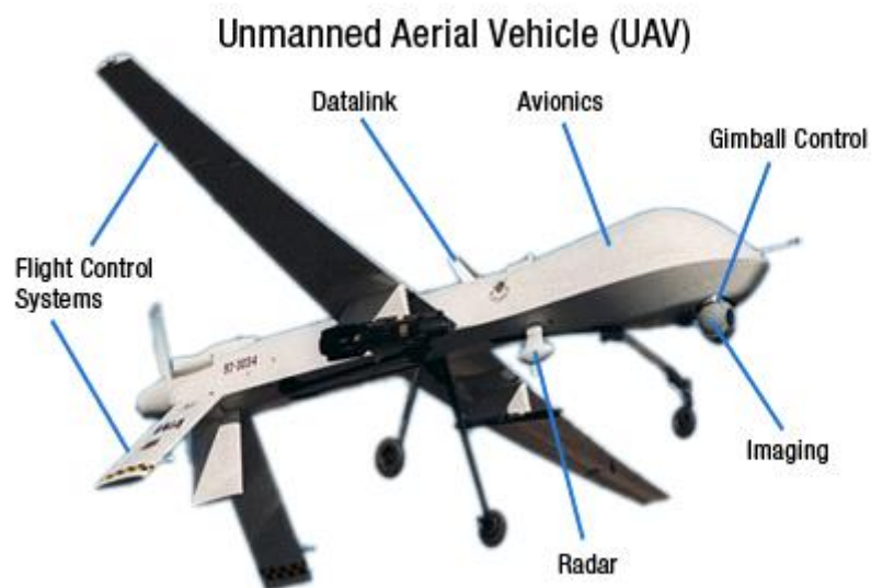
Εικόνα 10 UAV τύπου αεροπλάνου με υποδείξεις των επιμέρους μερών του
