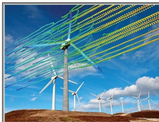
Εικόνα 5: Παράδειγμα εφαρμογής CFD στην πρόβλεψη της ροής αέρα πάνω σε μια ανεμογεννήτρια σε αιολικό πάρκο.
