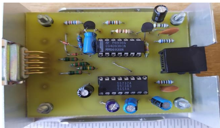
Εικόνα 19. Πλακέτα κυκλώματος σύνδεσης του Datalogger CR10X με Η/Υ.
