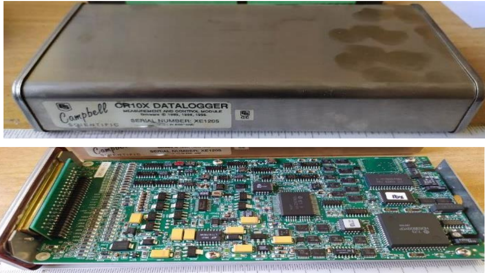
Εικόνα 16. Datalogger CR10X της εταιρίας Campbell. Διακρίνονται η εξωτερική θωράκιση της και η κεντρική πλακέτα.
