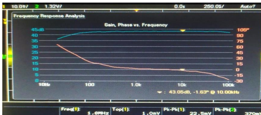
Εικόνα 27. Ενίσχυση πρώτης βαθμίδας δέκτη πολύ χαμηλών συχνοτήτων (γαλάζια απόκριση).
