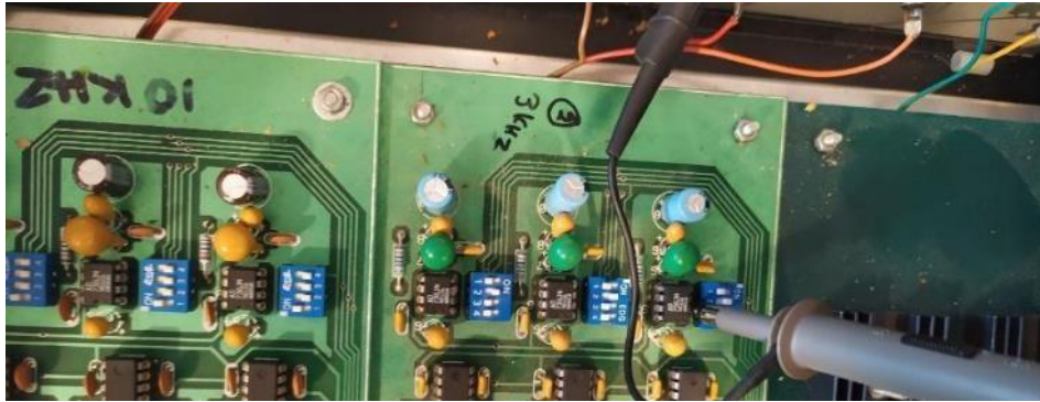
Εικόνα 26. Δέκτες 3 kHz και 10 kHz. Αρχικός έλεγχος επιβεβαίωσε δυσλειτουργία σχεδόν στο σύνολο της πρώτης βαθμίδας.
