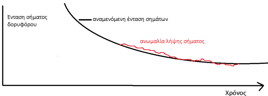
Εικόνα 3. Λήψη μη γεωστατικού δορυφόρου. Παρατηρείται έξαρση σήματος πριν τον σεισμό, ελάττωση μετά και εξομάλυνση πριν και μετά το φαινόμενο με παράθυρο 40 λεπτών για κάθε κατάσταση. Αναπαράσταση φαινομένου.
