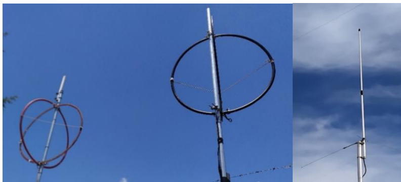
Εικόνα 34. Βρογχοκεραίες εγκατεστημένες επί αλουμινένιου στύλου, και κεραία κάθετης πόλωσης στους 46 MHz που χρησιμοποιήθηκαν για την πειραματική λειτουργία του σταθμού Ζακύνθου.
