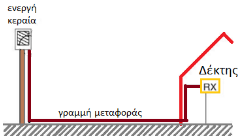
Εικόνα 44. Τυπικό διάγραμμα ρυθμίσεων ενεργής κεραίας MiniWhip.
