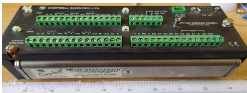
Εικόνα 15. Datalogger CR10X της εταιρίας Campbell. Διακρίνονται οι διαφορετικές εισοδοι και η σειριακή έξοδος. Εικόνα του datalogger από τον σταθμό λήψης Ζακύνθου.
