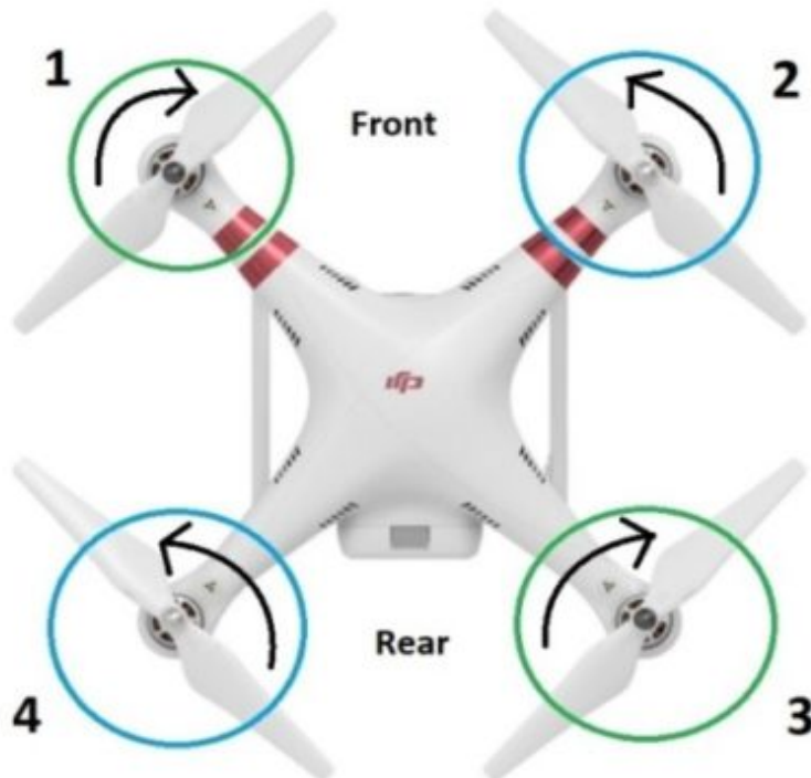
Εικόνα 37. Γωνιακή ταχύτητα των μοτέρ
