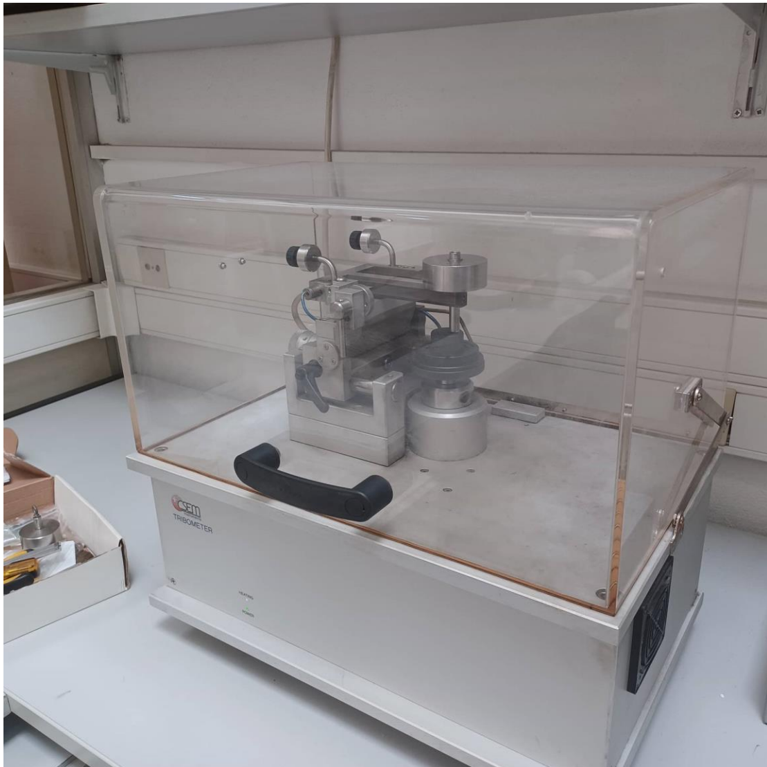
Εικόνα 8: Τριβόμετρο CSEM Instruments του εργαστηρίου.
