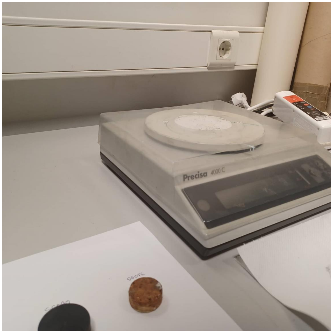
Εικόνα 5: Ζυγός ακριβείας 0.01 g του εργαστηρίου Precisa 4000C.
