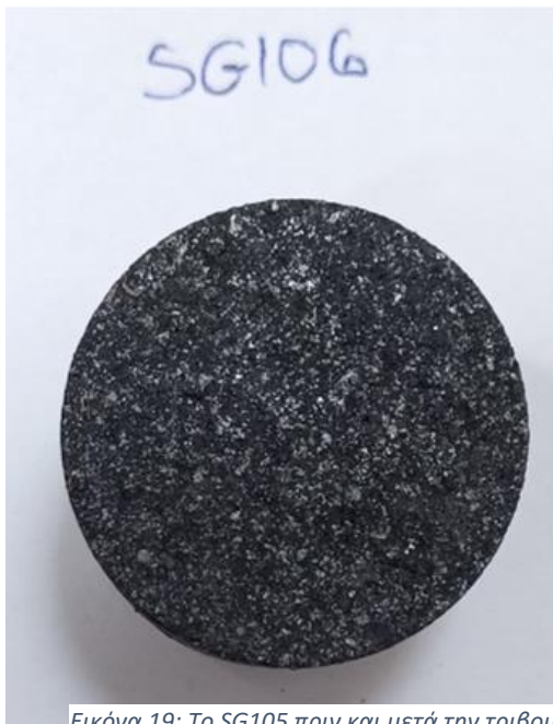
Εικόνα 19: Το SG105 πριν και μετά την τριβομέτρησή του. Στο κέντρο φαίνεται η επιφάνεια, η οποία έχει καταπονηθεί σε μηχανική διάβρωση – σπηλαιώση (πάνω) και Το SG105 μετά την τριβολογική του δοκιμή με λεπτομέρειες (κάτω).
