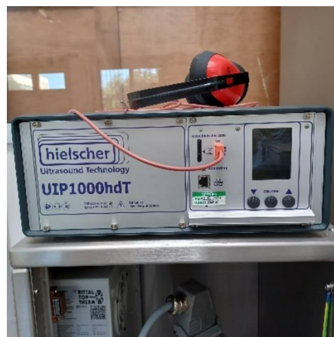
Εικόνα 7: Συσκευή μηχανικής διάβρωσης – σπηλαιώσης UIP1000hdT (αριστερά), Κεφαλή-Horn tip (πάνω δεξιά) και συσκευή ρύθμισης παραμέτρων για τη δοκιμή μηχανικής διάβρωσης - σπηλαιώσης (κάτω δεξιά).
