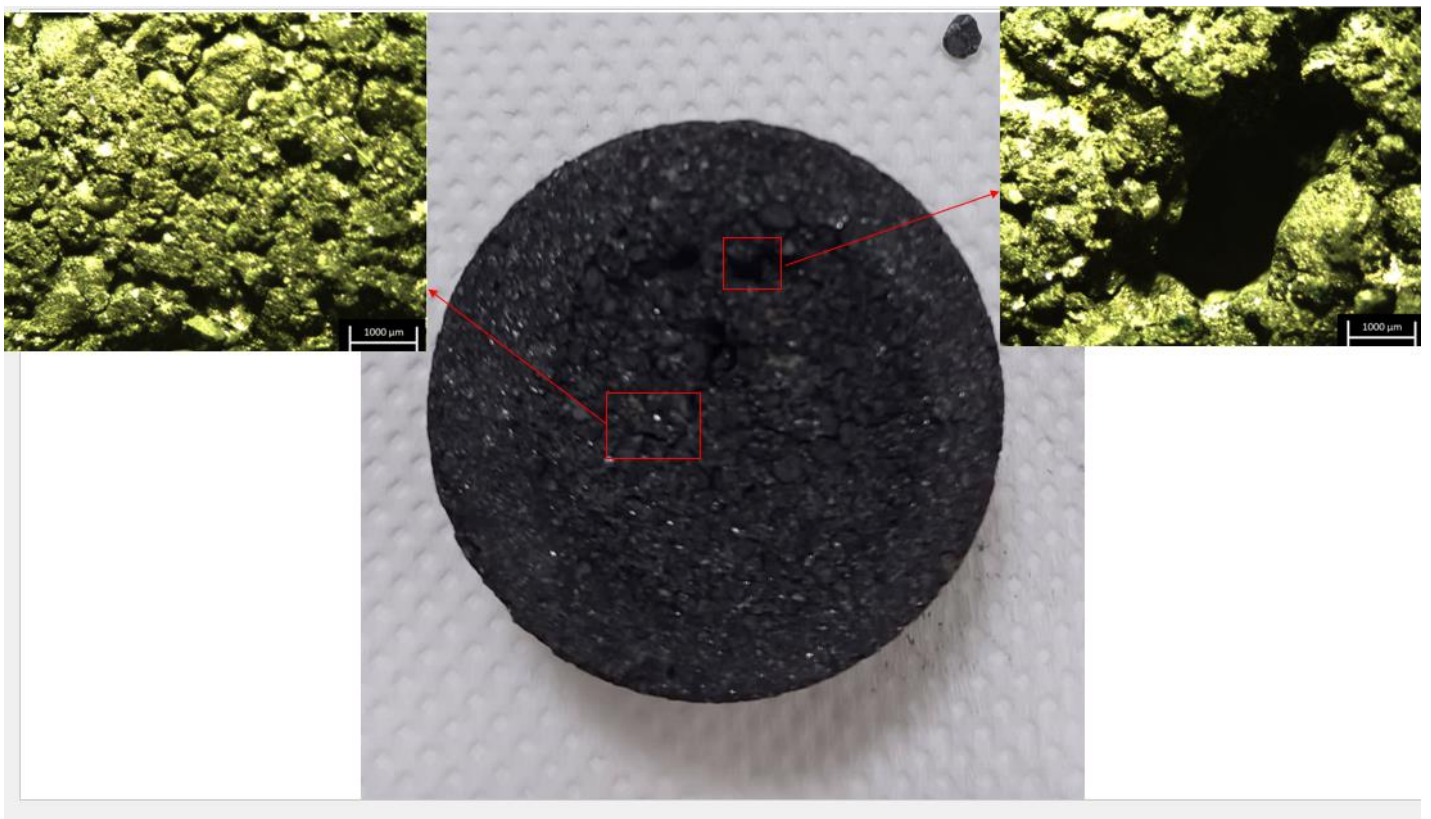
Εικόνα 11: Το SG105 μετά από δοκιμή μηχανικής διάβρωσης - σπηλαιώσης και λεπτομέρειες επιφάνειας
