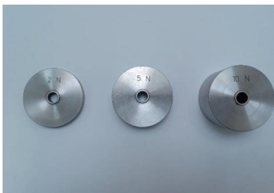
Εικόνα 9: Χρησιμοποιημένα μπιλία από Al_2O_3 (πάνω), Τα βαρίδια 2N, 5N και 10N που χρησιμοποιήθηκαν στις δοκιμές τριβής (κάτω).
