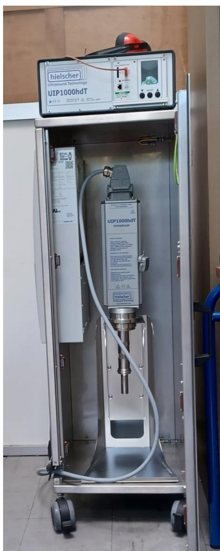
Εικόνα 7: Συσκευή μηχανικής διάβρωσης – σπηλαιώσης UIP1000hdT (αριστερά), Κεφαλή-Horn tip (πάνω δεξιά) και συσκευή ρύθμισης παραμέτρων για τη δοκιμή μηχανικής διάβρωσης - σπηλαιώσης (κάτω δεξιά).
