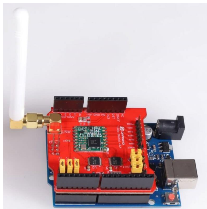
Εικόνα 48: Το Dragino τοποθετημένο πάνω σε Arduino Uno
