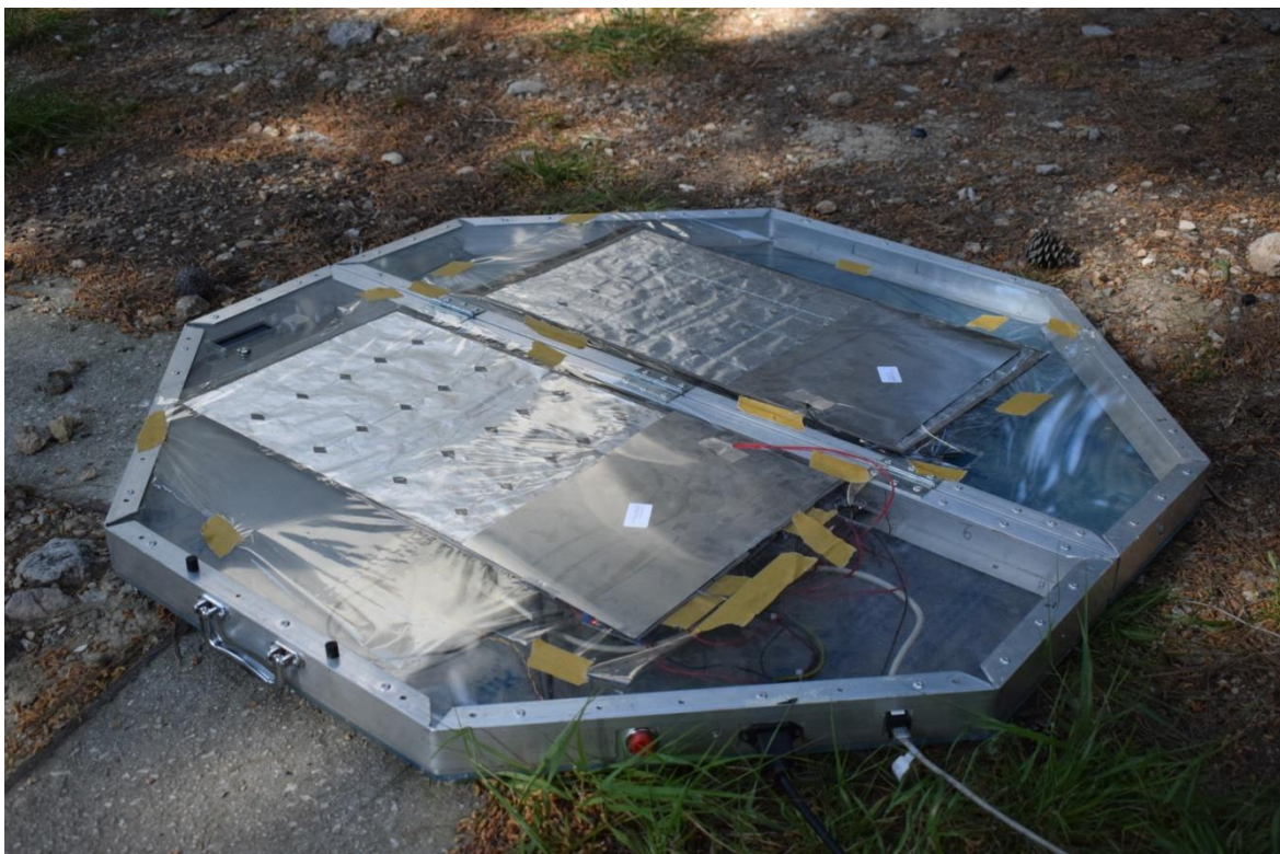
Εικόνα 27: Τοποθέτηση σταθμού φόρτισης στο έδαφος
