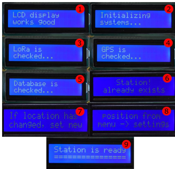
Εικόνα 40: Τοποθέτηση και αρχικοποίηση, ήδη εγγεγραμμένου σταθμού στο δίκτυο
