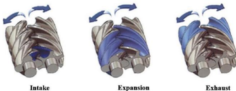
Εικόνα 5.3. Λειτουργία του Ελικοειδής Εκτονωτή
