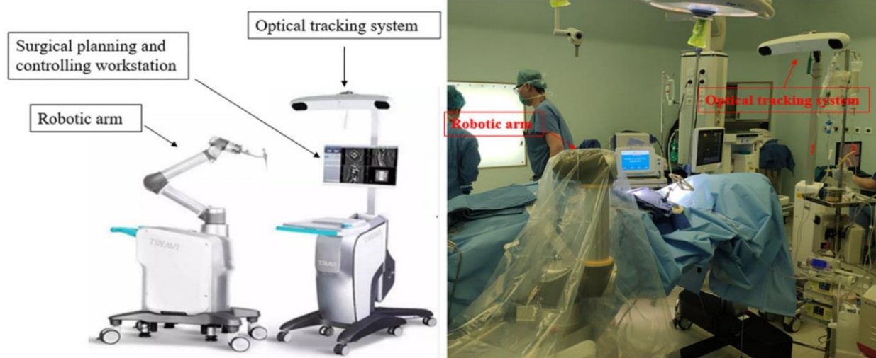
Εικόνα 17. Η δομή του TiRobot αποτελείται από έναν βραχίονα, ένα σταθμό εργασίας για τον έλεγχο και τον σχεδιασμό του χειρουργείου και μια συσκευή παρακολούθησης. (Xin-Jin Su, 2020)
