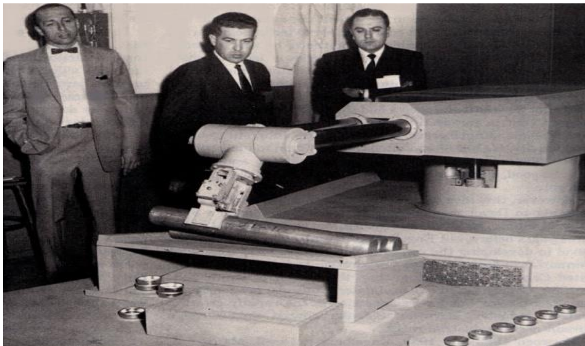
Εικόνα 3. Η εφαρμογή του πρώτου βιομηχανικού ρομπότ το 1961 (Project, 2015)
