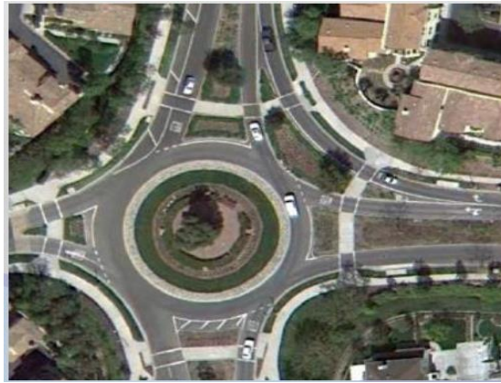
Εικόνα 54: Τετρασκελής υπεραστικός κόμβος μονής λωρίδας με παρακαμπτήρια λωρίδα
