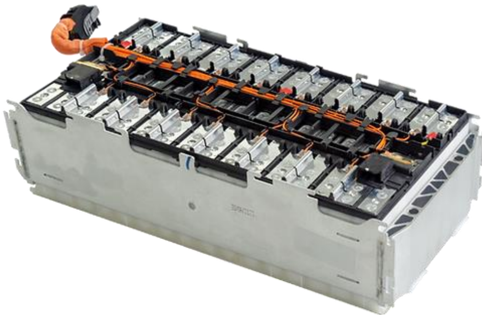
Εικόνα 2.2.3.1 Μπαταρία έλξης η οποία περιέχει πολλές κυψέλες μέσα στην μονάδα. (evfiresafe.com)
