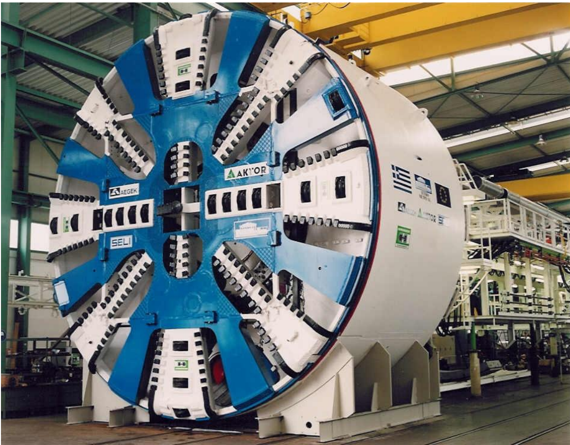
Εικόνα 5: Μηχάνημα διάνοιξης σιράγγων (TBM) – Αττικό μετρό (2)
