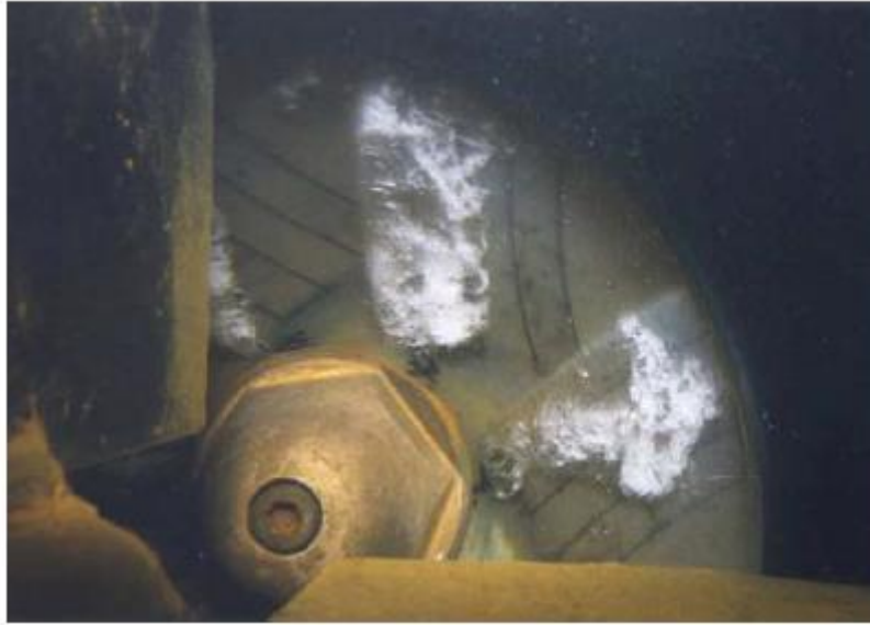
Εικόνα 5: Σπηλαιώση στην είσοδο της περωτής
