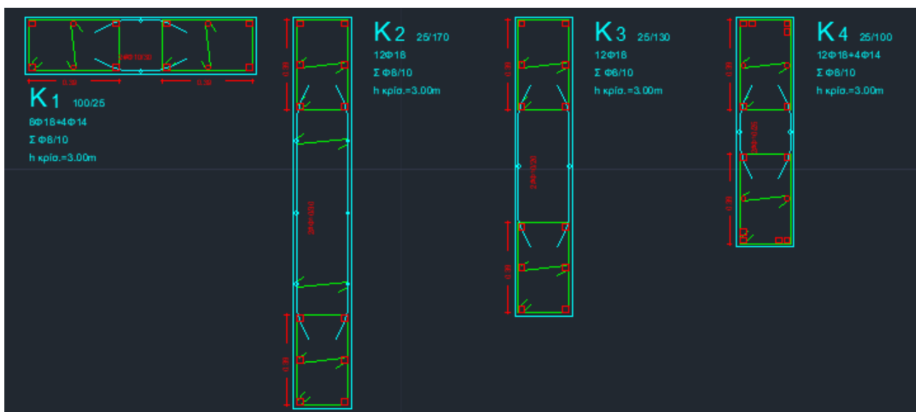
Εικόνα 47. Κλωβοί όπλισης Υποστυλωμάτων και τοιχίων K1,K2, K3, K4 από Μελετητή.
