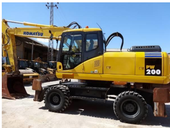
Εικόνα 30. Εκσκαφέας Komatsu PW200-7
