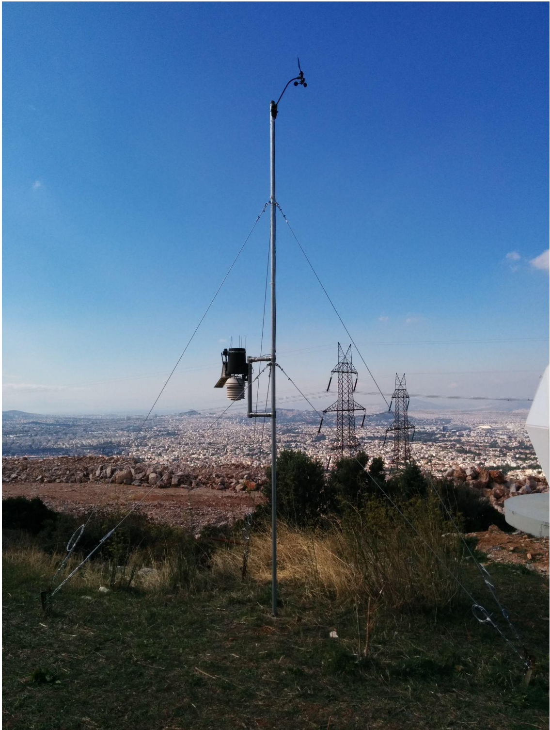
Εικόνα 5.1: Αυτόματος μετεωρολογικός σταθμός στο Ε.Α.Α. στην Π. Πεντέλη.
