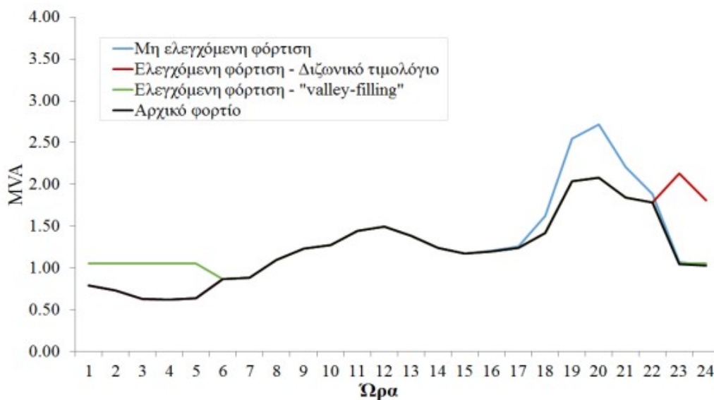
Εικόνα 3.16 Τροποποιημένη καμπύλη φορτίου του δικτύου της Ικαρίας για το μέγιστο φορτίο (καλοκαιρινή μέρα)
