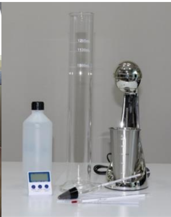
Εικόνα 3.5 - Εξοπλισμός κοκκομετρικής ανάλυσης με πικνόμετρο
