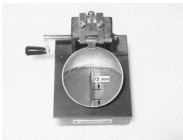
Εικόνα 3.1 – Προσδιορισμός Ορίου Υδαρότητας στη συσκευή Casagrande
