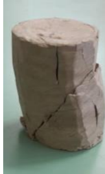
Εικόνα 3.7 – Θραύση κυλινδρικού δοκιμίου
