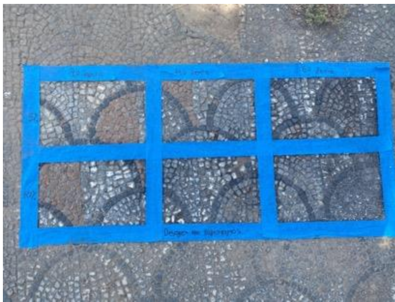
Εικόνα 137. Μετά τον χημικό καθαρισμό με Desogen σε χαρτοπολτό.
