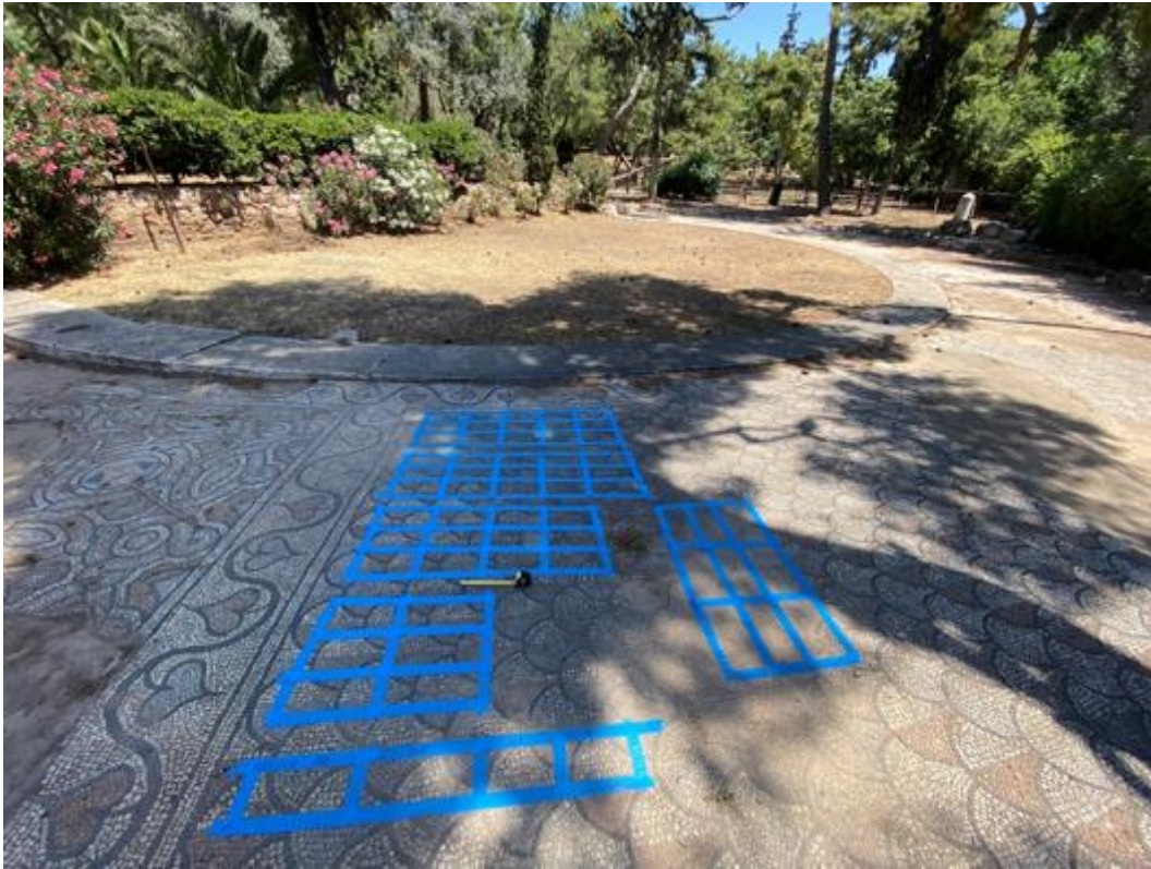
Εικόνα 107. Προετοιμασία των παραλληλόγραμμων, που θα εφαρμοστούν οι δοκιμές των χημικών καθαρισμών.
