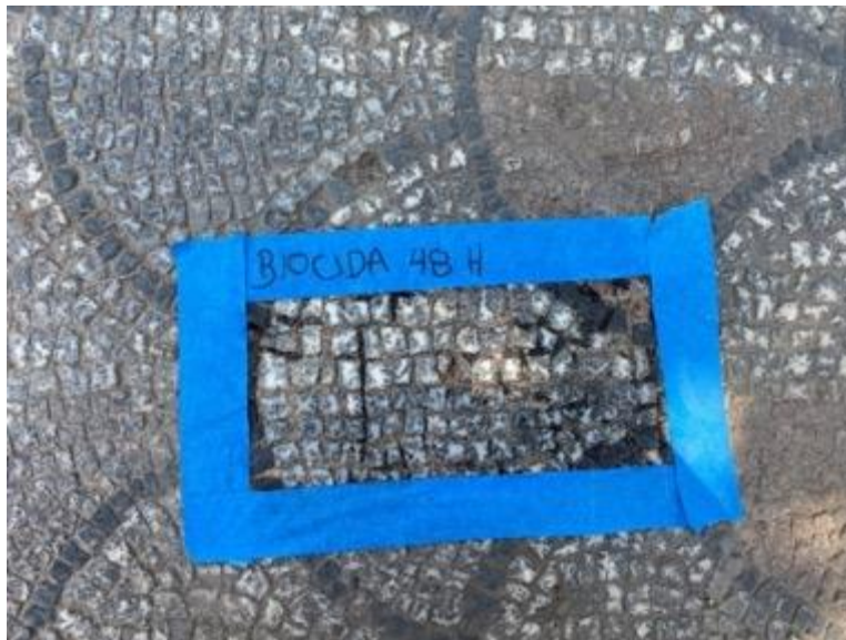
Εικόνα 145. Η ψηφιδωτή επιφάνεια μετά την αφαίρεση του Biocida από τις 48 ώρες.
