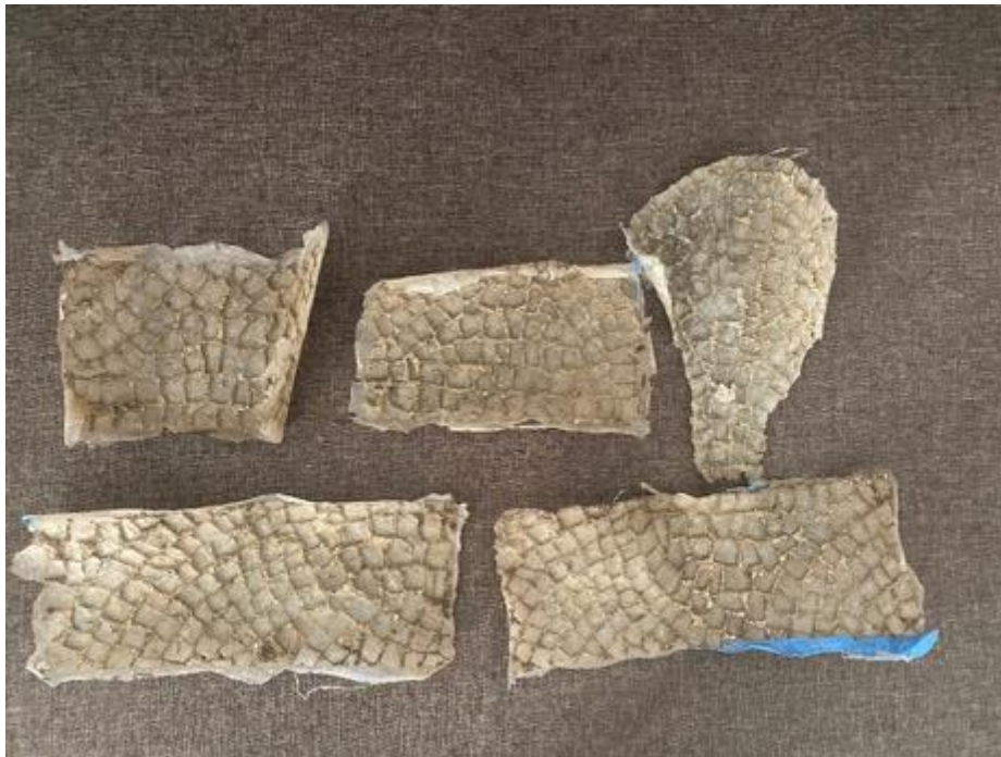
Εικόνα 149. Η εσωτερική πλευρά του φιλμ, που δημιουργήθηκε από την πάστα Biocida μετά την αφαίρεσή του.
