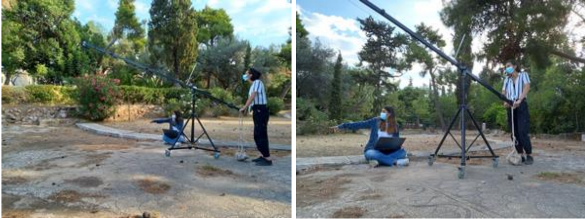
Εικόνες 22-23. Στιγμιότυπο από τη διαδικασία φωτογραμμετρίας στο πεδίο.
