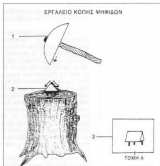
Εικόνα 21. 1.Σιδερένιο εργαλείο κοπής ψηφίδων, 2.Σιδερένιο στέλεχος τριγωνικής διατομής εκτονώνονται οι δυνάμεις που ασκούνται κατά την κοπή της ψηφίδας, 3. Απεικόνισή της πλάγιας όψης του σιδερένιου στελέχους. (©Αθηναίτου-Ζαχαροπούλου)
