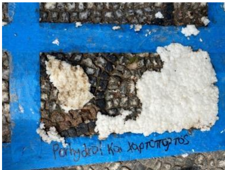
Εικόνα 128. Παραμονή υπολειμμάτων του επιθέματος στο ψηφιδωτό, όταν δε χρησιμοποιείται το διηθητικό χαρτί.
