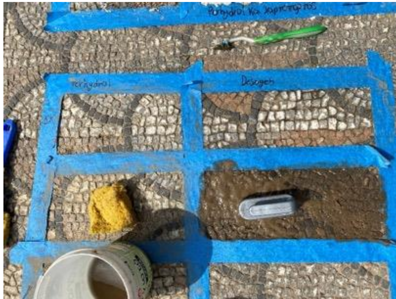
Εικόνα 132. Τα διαλύματα perhydrol και desogen κατά τη χρήση τους
