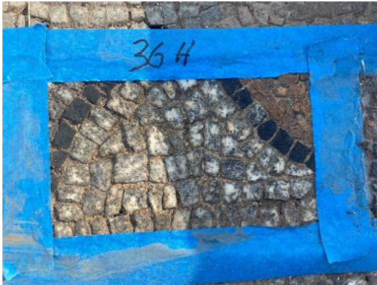
Εικόνα 144. Η ψηφιδωτή επιφάνεια μετά την αφαίρεση του Biocida έπειτα από 36 ώρες..
