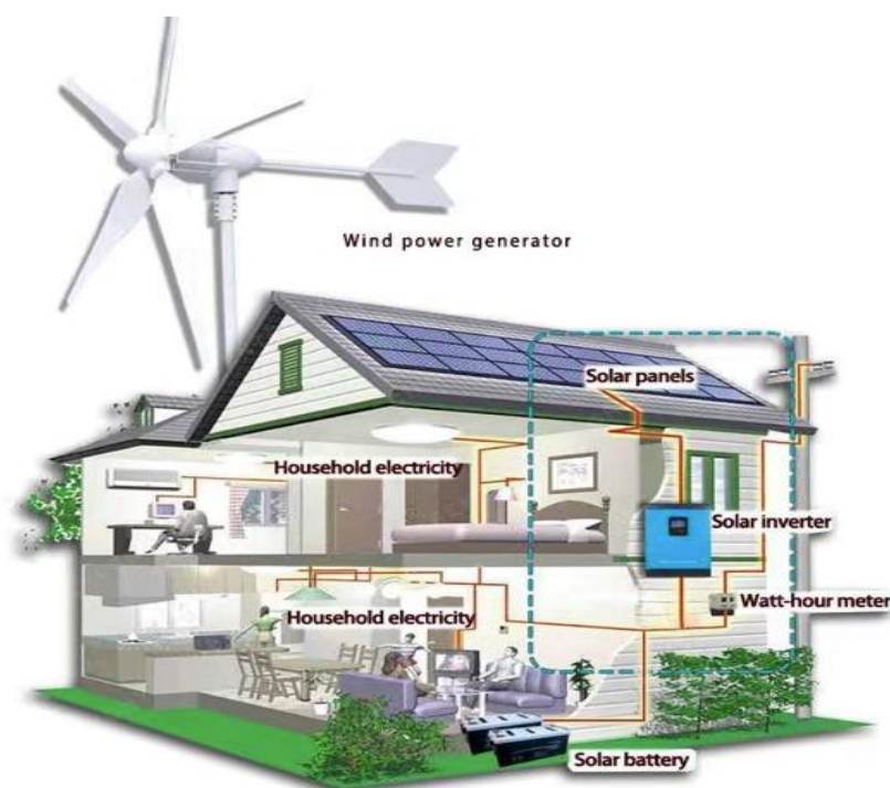
Εικόνα 8: Απεικόνιση ενός υβριδικού συστήματος παραγωγής ηλεκτρικής ενέργειας με χρήση Φ/Β-Α/Γ εγκατεστημένο σε οικία.
