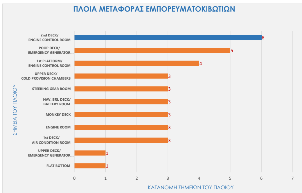
Διάγραμμα 4.13: Τα επικίνδυνα υλικά που συχνότερα εντοπίστηκαν στα μέρη τα πλοίων κατά είδος για την περίπτωση των πλοίων μεταφοράς εμπορευματοκιβωτίων ( container vessels )
